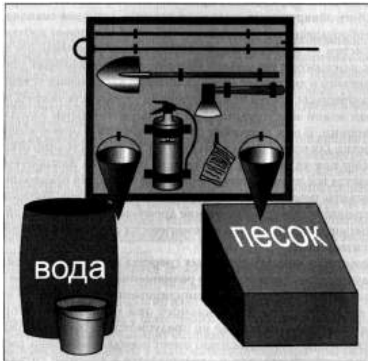
Рисунок 1. Пожарный щит первичных средств пожаротушения
