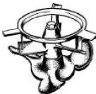
Рисунок 8. Рабочий орган турбосмесителя
