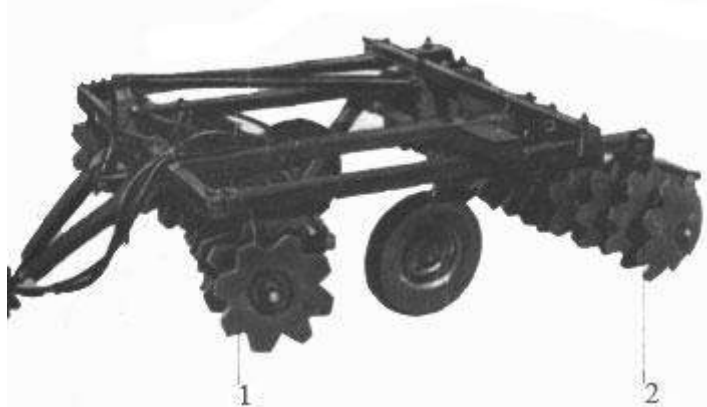
Рис. 2. Борона дисковая тяжелая прицепная гидрофицированная: 1 — передняя батарея дисков; 2 — задняя батарея дисков.
