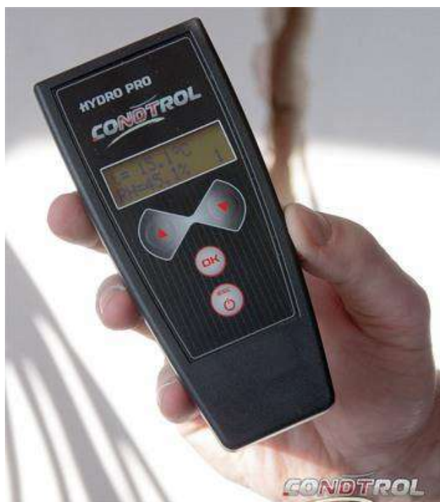
Рисунок 6.5.-Влагомер, работающий на принципе диэлькометрического метода
