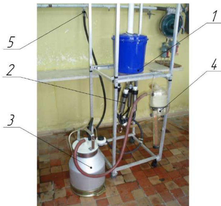
Рисунок 8.4 – Общий вид лабораторной установки для определения погрешности измерения УЗМ-1А
