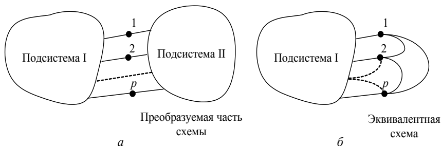
Рис. 1.12. Условное изображение ЭЭС с эквивалентруемой частью:
