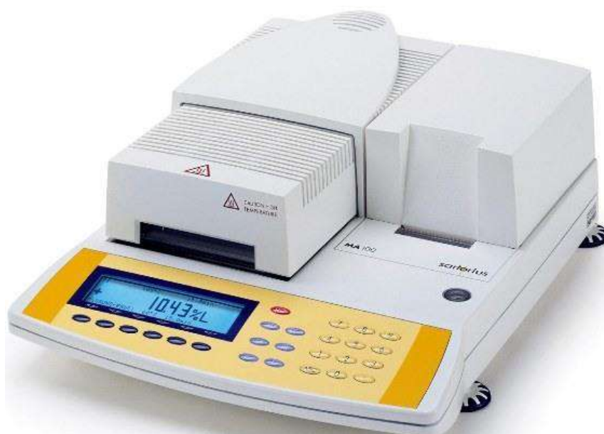
Рисунок 6.1.-Влагомер, работающий на принципе весового метода
