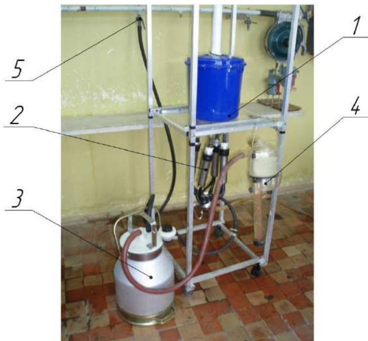
Рисунок 8.4 – Общий вид лабораторной установки для определения погрешности измерения УЗМ-1А
