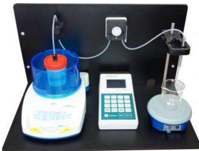
Рисунок 9.1.- Общий вид лабораторного комплекта «Титрион-Милк»
