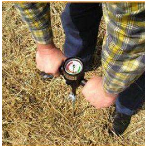
Рисунок 2.3.- Процесс измерение плотности почвы
