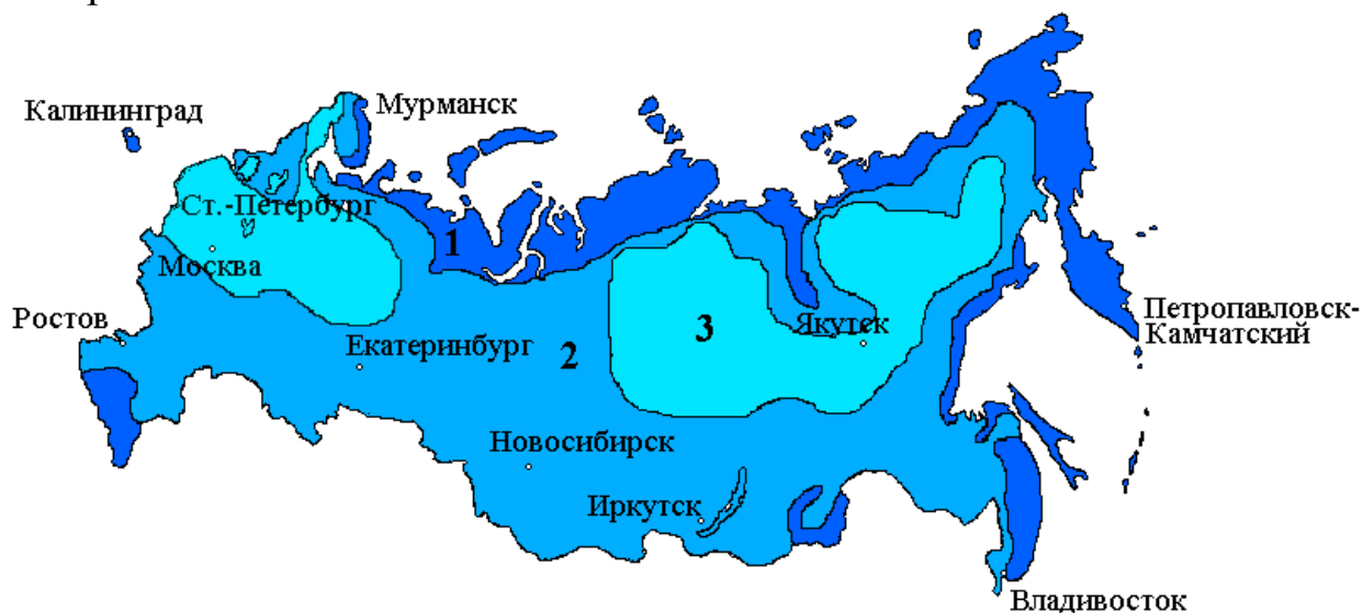
Рис. 4.3 – Карта ветроэнергетических ресурсов России. Цифрами обозначены зоны со среднегодовыми скоростями ветра: 1 – выше 6 м/сек; 2 – от 3,5 до 6 м/сек; 3 – до 3,5 м/сек.
