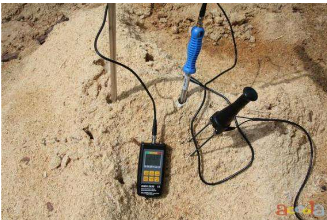
Рисунок 3.2.- Процесс измерения рН почвы
