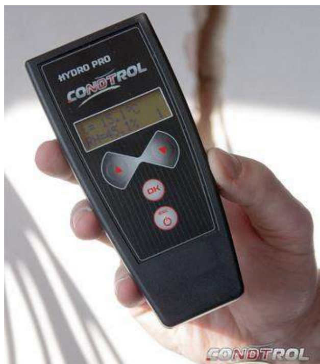
Рисунок 6.5.-Влагомер, работающий на принципе диэлькометрического метода
