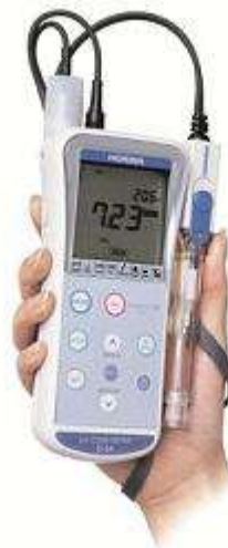
Рисунок 3.3.-Общий вид портативного измерителя рН и ЕС-D-54
