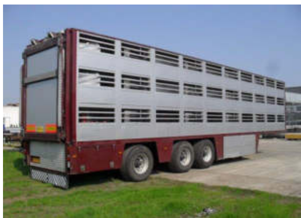
Рисунок 2 – Полуприцеп-скотовоз «Verdex» на 200 голов свиней.
