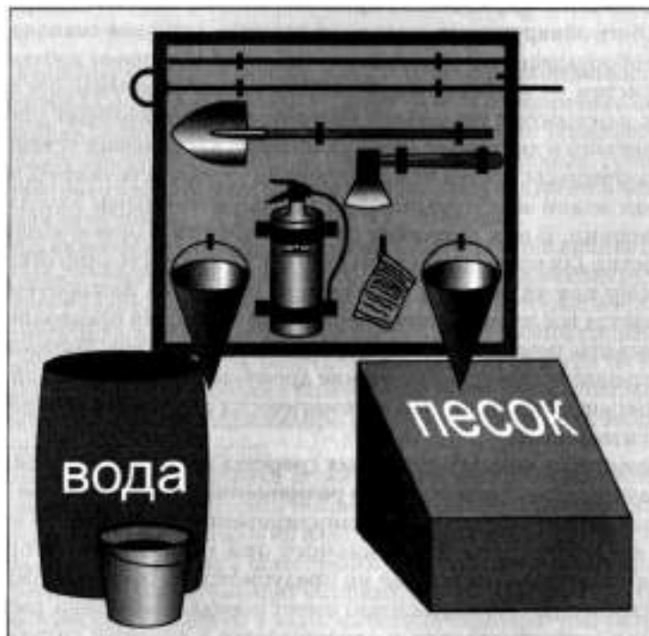
Рисунок 1. Пожарный щит первичных средств пожаротушения
