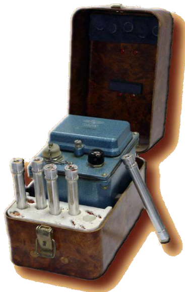
Рисунок 10 Комплект дозиметров ДП-24
