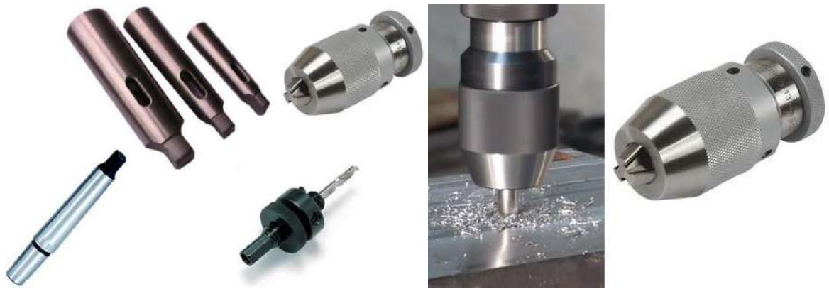
Рисунок 17. Вспомогательные инструменты для сверления
