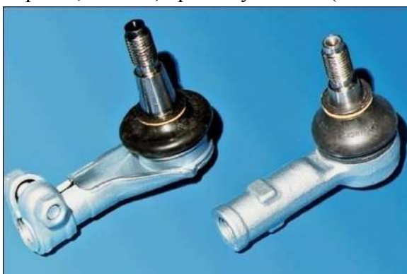
Рис. 32 Шарнир рулевого привода с шаровым пальцем
