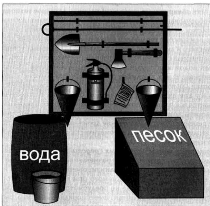
Рисунок 1. Пожарный щит первичных средств пожаротушения
