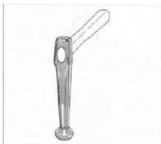
Рис. 5. Молоток для правки глубокотянутых деталей кузова
