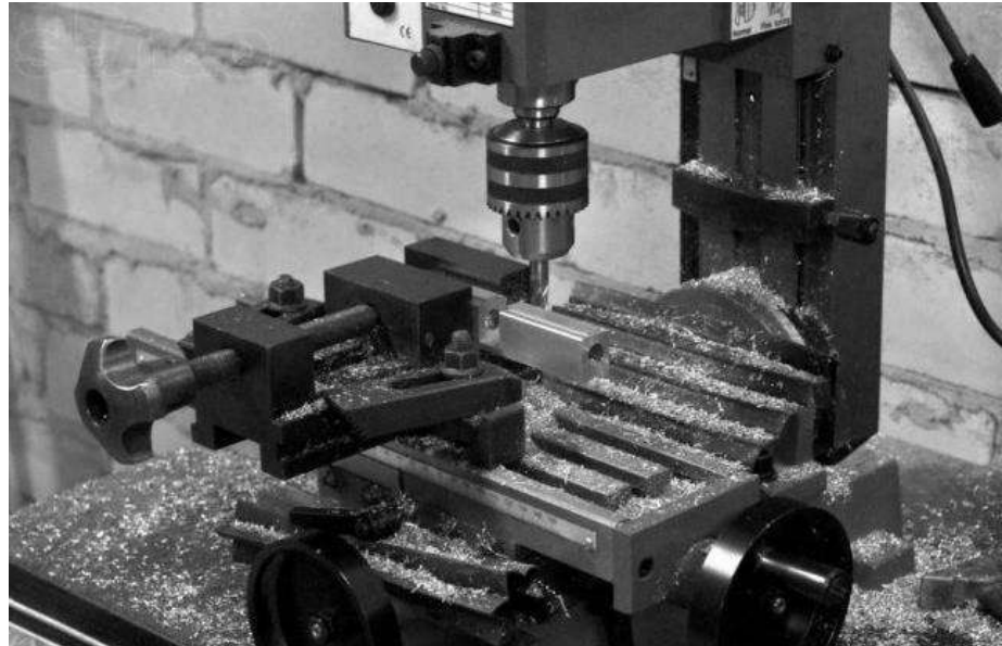
Рисунок 38.1. Сверление заготовки закрепленной в тисках.
