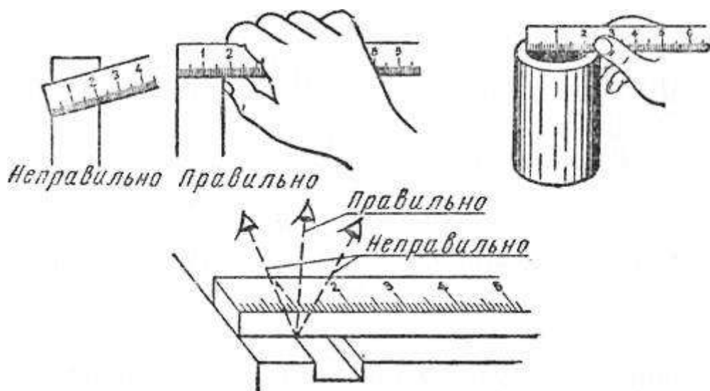
Рисунок 3.1. Измерение объекта с помощью линейки
