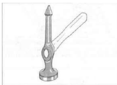
Рис. 2. - Молоток с заостренной рабочей поверхностью.
