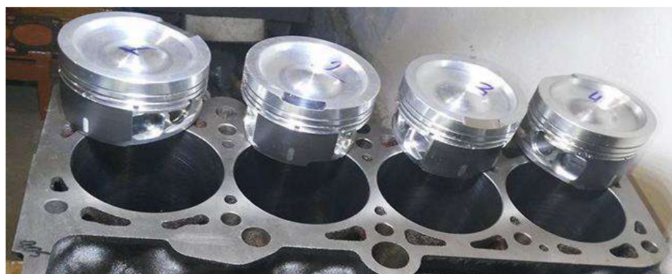
Рисунок 2. Поршни следующего ремонтного размера
