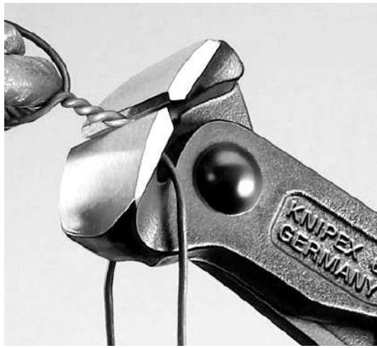
Рисунок 19.1. Резка проволоки острогубцами
