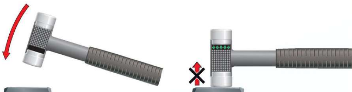
Рисунок 2.2. Принцип работы молотка без отдачи:
