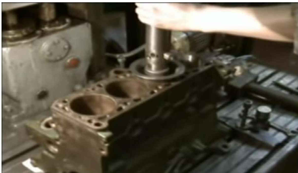
Рисунок 1. Процесс расточки блока цилиндров двигателя
