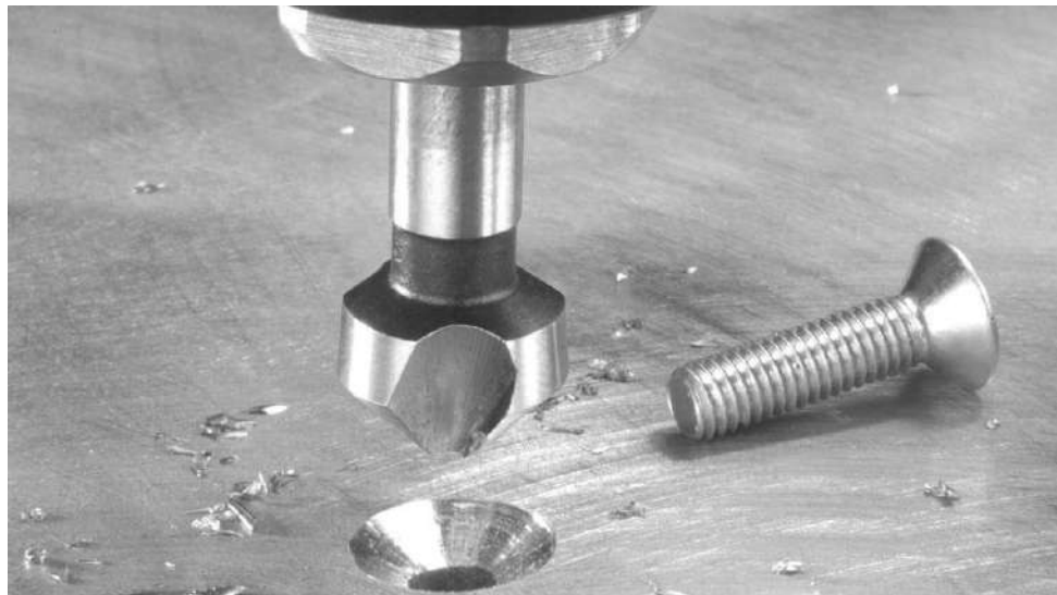
Рисунок 40.2. Коническое зенкерование отверстий
