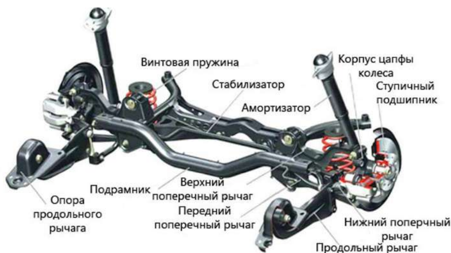
Рисунок 10. Многорычажная задняя подвеска
