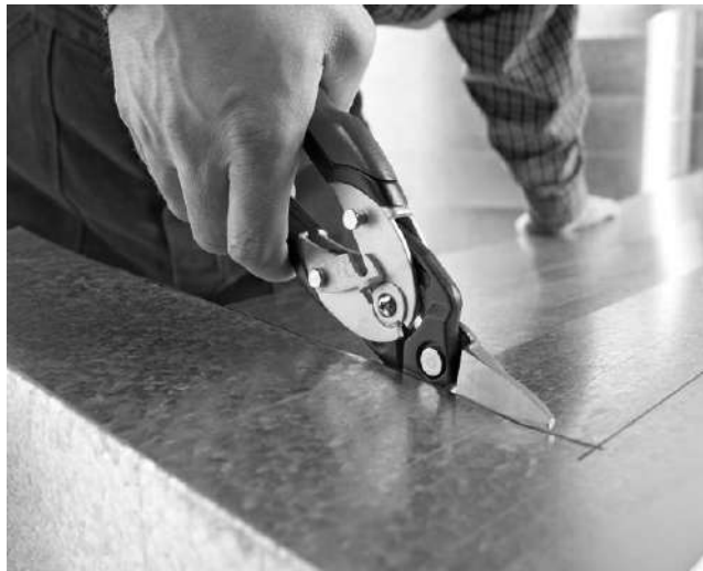
Рисунок 19.2. Положение пальцев на рукоятке при резании ножницами
