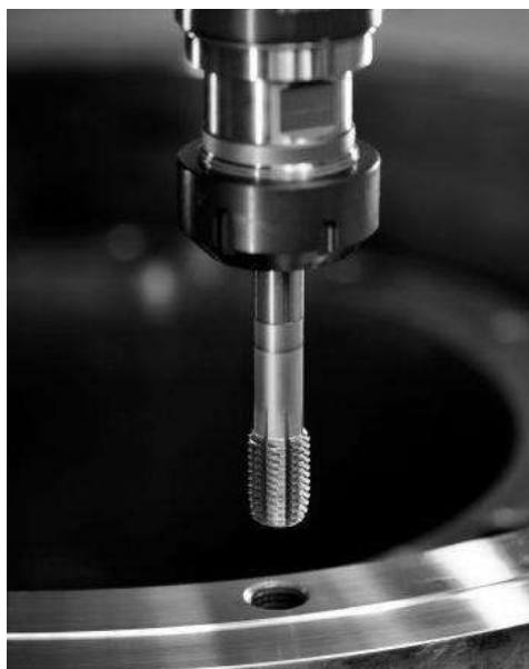
Рисунок 46.2. Прием нарезания резьбы на сверлильном станке.
