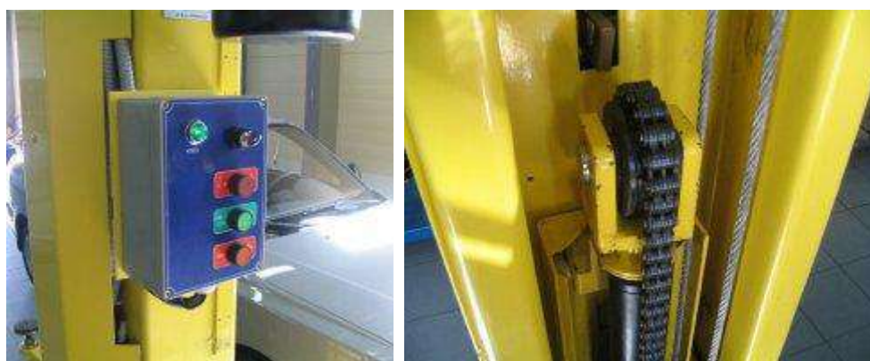
Рисунок 10 Оборудование подъемников с электрогидравлическим приводом
