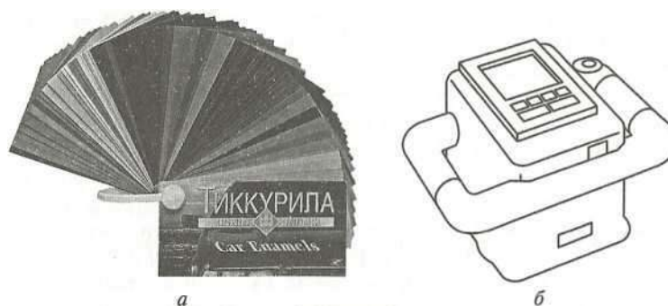
Рис. 2. - Набор ручных тест-пластин (а) и светофотометр (б)
