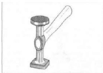
Рис. 1. - Молоток с насечкой рабочей поверхности
