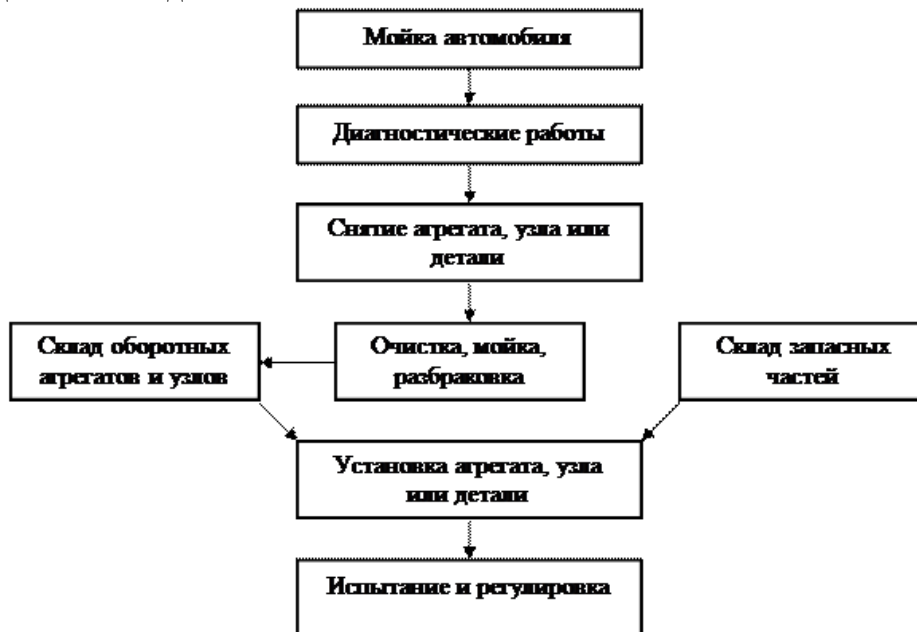
Рис. 1. Схема технологического процесса ремонта автомобилей в процессе их эксплуатации (постовые работы)
