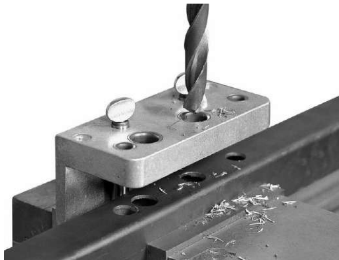
Рисунок 38.2. Сверление отверстий по шаблону
