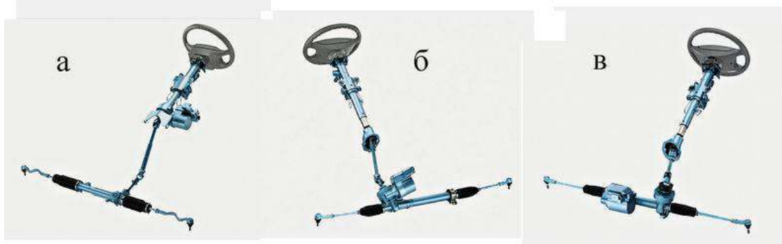
Рис. 38 Электрические усилители рулевого управления: а — с воздействием на рулевой вал; б — с воздействием на шестерню рулевого механизма; в — с воздействием на рейку рулевого механизма
