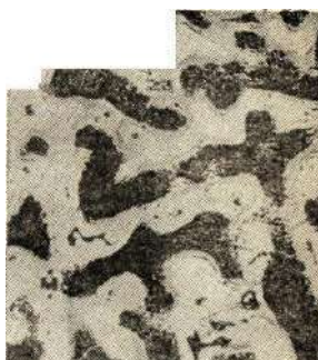
Рисунок 1.3. Микроструктура литой оловянистой бронзы Br.010
