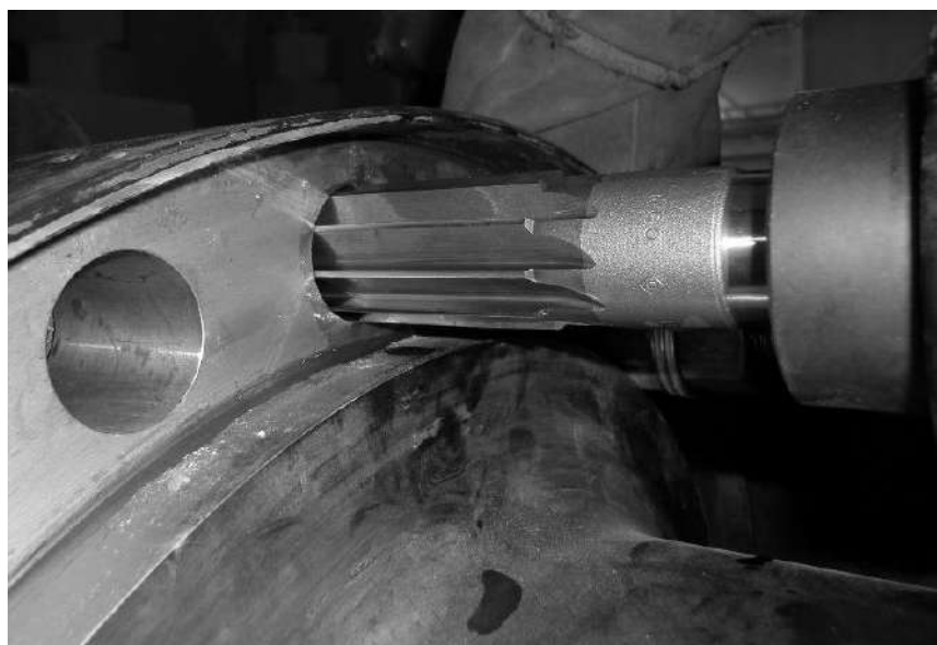
Рисунок 41.2. Развертывание отверстий машинной разверткой
