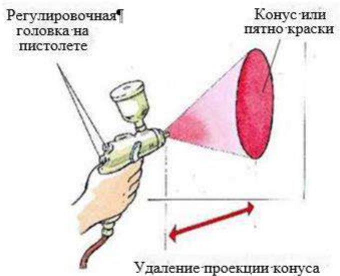
Рисунок 2 - Регулировка окрасочного пистолета.
