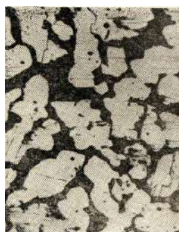
Рисунок 1.2. Микроструктура литой латуни LC59-1 (X200).
