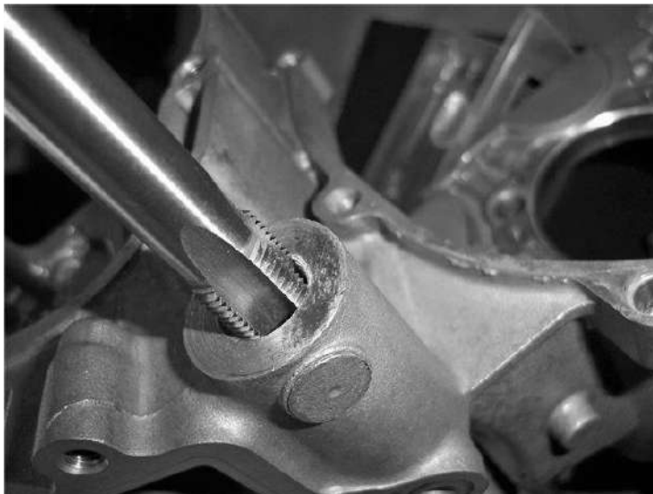
Рисунок 45.2. Нарезание метчиком внутренней резьбы
