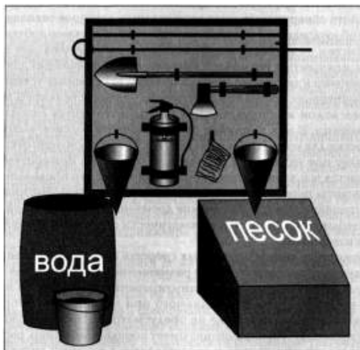
Рисунок 1. Пожарный щит первичных средств пожаротушения
