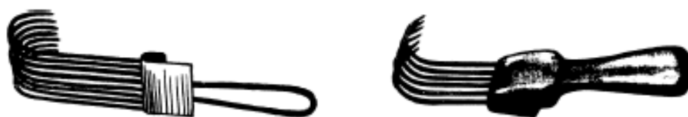
Рисунок 65 – Гребенки для вычесывания пуха
