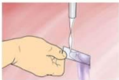
Удаление раствора водой
