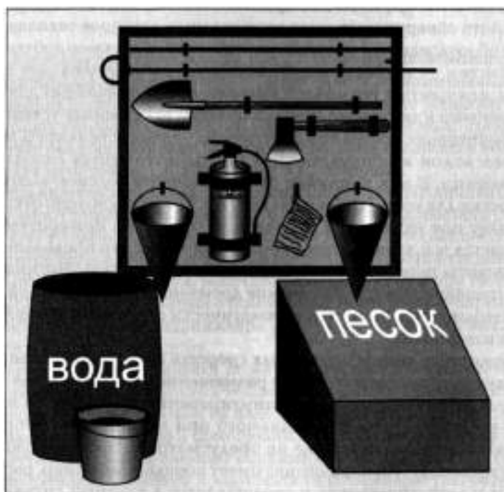
Рисунок 1. Пожарный щит первичных средств пожаротушения
