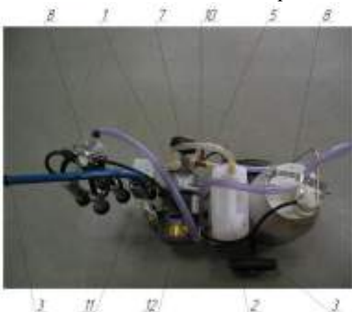
Рис. 1 Установка доильная передвижная АИД-1 (вид сверху)
