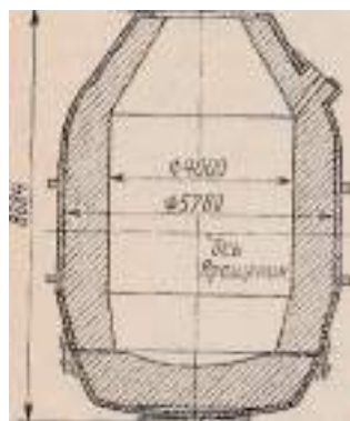
Схема конвертора с подачей кислорода сверху
