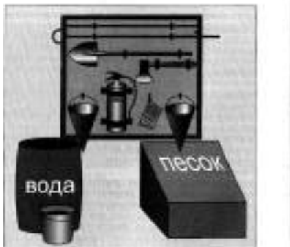
Рисунок 1. Пожарный щит первичных средств пожаротушения
