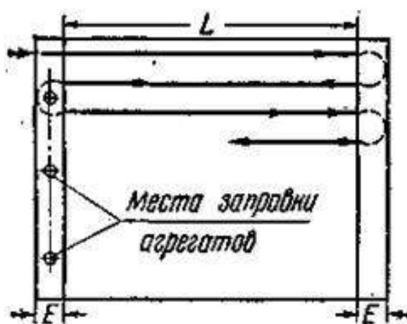
Рис. 3. Схема движения агрегата челночным способом на внесении минеральных удобрений (длина гона меньше запаса рабочего хода).
