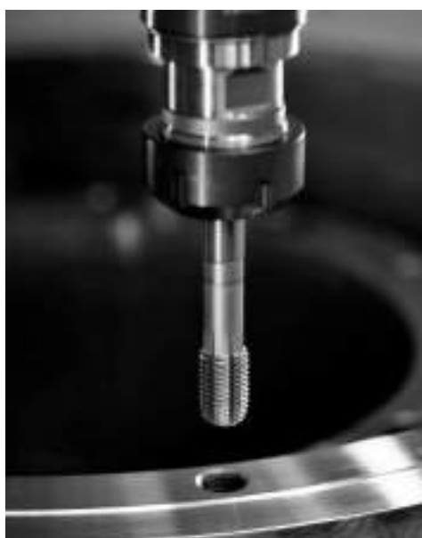
Рисунок 2 - Прием нарезания резьбы на сверлильном станке.
