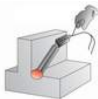
Рис. 6. Сварка двумя параллельными электродами
