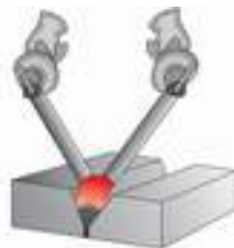
Рис. 5. Сварка двумя электродами, в двух электрододержателях
