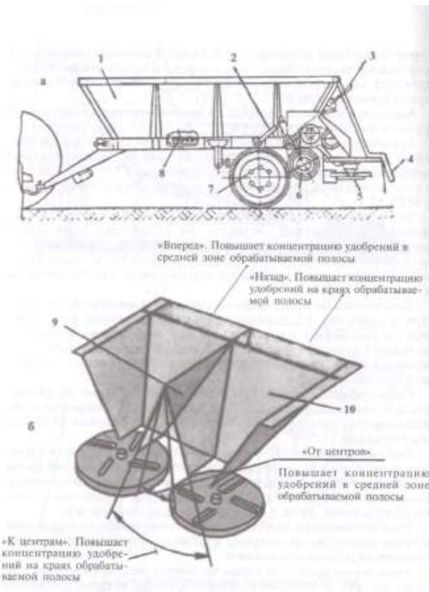
а — схема работы; б — схема тукоделителя; 1 — кузов; 2 — гидроцилиндр; 3 — дозирующее устройство; 4 - ветрозащитное устройство; 5 — диски; 6 — ролик; 7 — ходовое колесо; 8 — транспортер; 9 - шарнирная стенка; 10 - тукоделитель.
