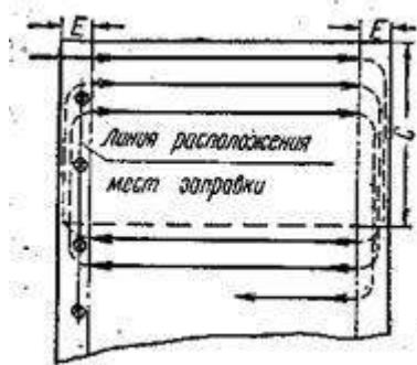
Рис. 5. Схема движения агрегата перекрытием на внесении минеральных удобрений.
