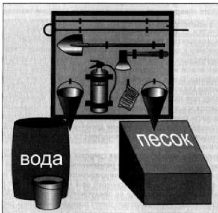
Рисунок 1. Пожарный щит первичных средств пожаротушения
