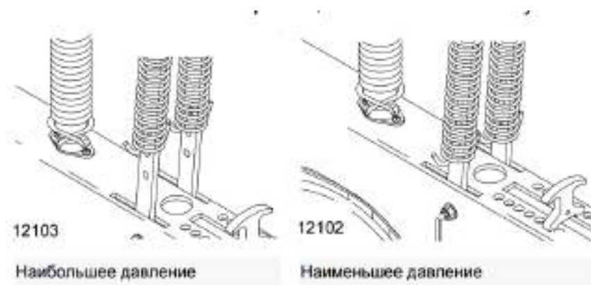
Рисунок 1 – Регулировка пружины сошника
