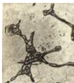
Рисунок 1.5. Микроструктура деформированного алюминиевого сплава Д1 после закалки в воде и естественного старения (X200)
