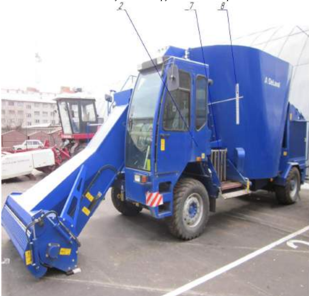
Рисунок 4 - Самоходный смеситель-раздатчик кормов (вид справа)
