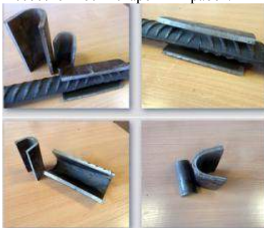
Рис. 13. Ванночки для сварки арматуры
