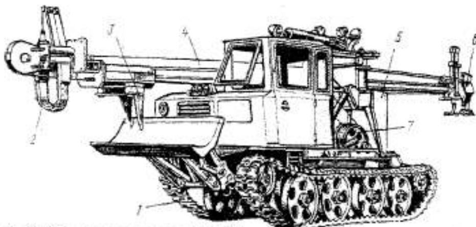
Рис. 62. Сучкорезная машина ЛП-30Г: 1 – трактор; 2 – приемная головка; 3 – захват; 4 – стрела; 5 – опора; 6 – сучкорезная головка; 7 – лебедка
