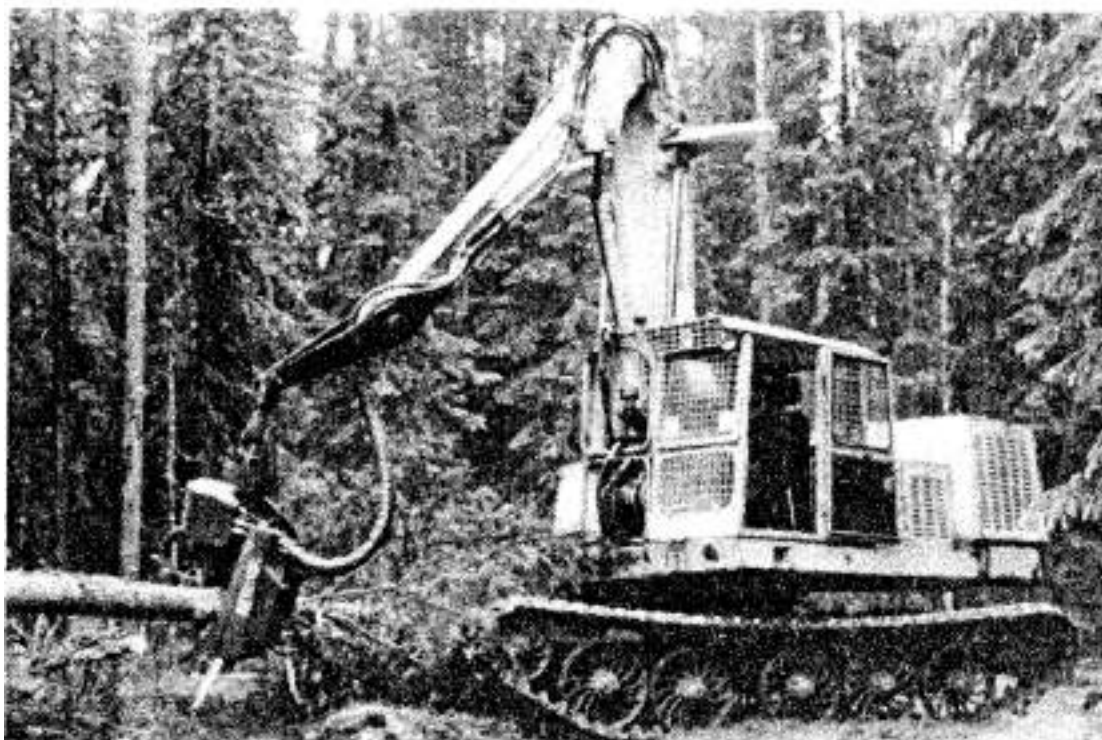
Рис. 2.37. Валочно-сучкорезно-раскряжевочная машина (харвестер) с сучкорезной головкой КЕТО-150
