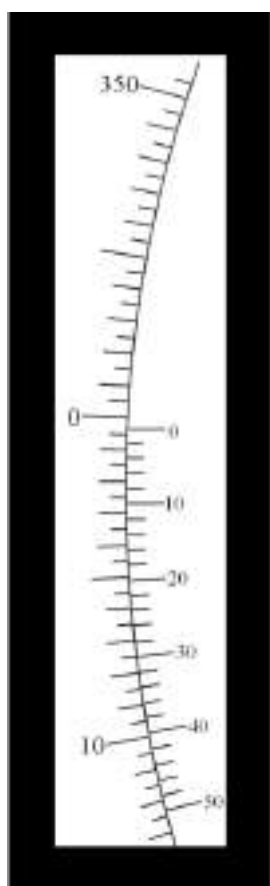
Для измерения угла пользуются лимбом и отсчетными устройствами. На лимбе нанесена 360-градусная шкала с ценой деления 0,5 градуса (рис.6 а). На корпусе закреплены нониусы отсчетных устройств. Каждый нониус имеет 25 делений с ценой деления 0,02 градуса. Если нулевой штрих нониуса оказался относительно нулевого штриха лимба смещенным по часовой стрелке, то поправка на ноль берется со знаком "+", если - против часовой стрелки - со знаком "-". Отсчет
