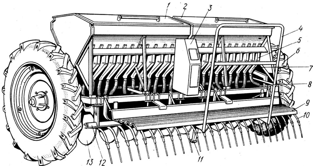
1 — отделение зернотукового ящика для удобрений; 2- отделение для семян; 3 — редуктор; 4 — поручень; 5 — катушечно-штифтовый туковый высеваящий аппарат; 6 — опорно-приводное колесо; 7 — воронка; 8-семяпровод; 9 — подножка; 10 — пружинный загортач; 11 — опорная лапа; 12 — кронштейн цепных загортачей; 13 — дисковый сошник
