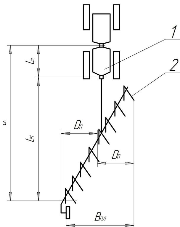
1 – трактор; 2 – плуг;  $l_k$  - кинематическая длина агрегата;  $l_m$  - кинематическая длина трактора;  $l_n$  - кинематическая длина плуга.
