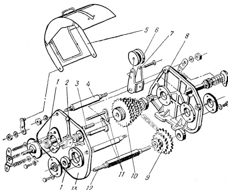
1 — подшипник; 2 — рукоятка; 3 и 12 — валы; 4 — стяжка; 5 — крышка; 6 — ролик; 7 — кронштейн; 8 и 13 — боковины; 9 и 10 — блоки; 11 — стопор.
