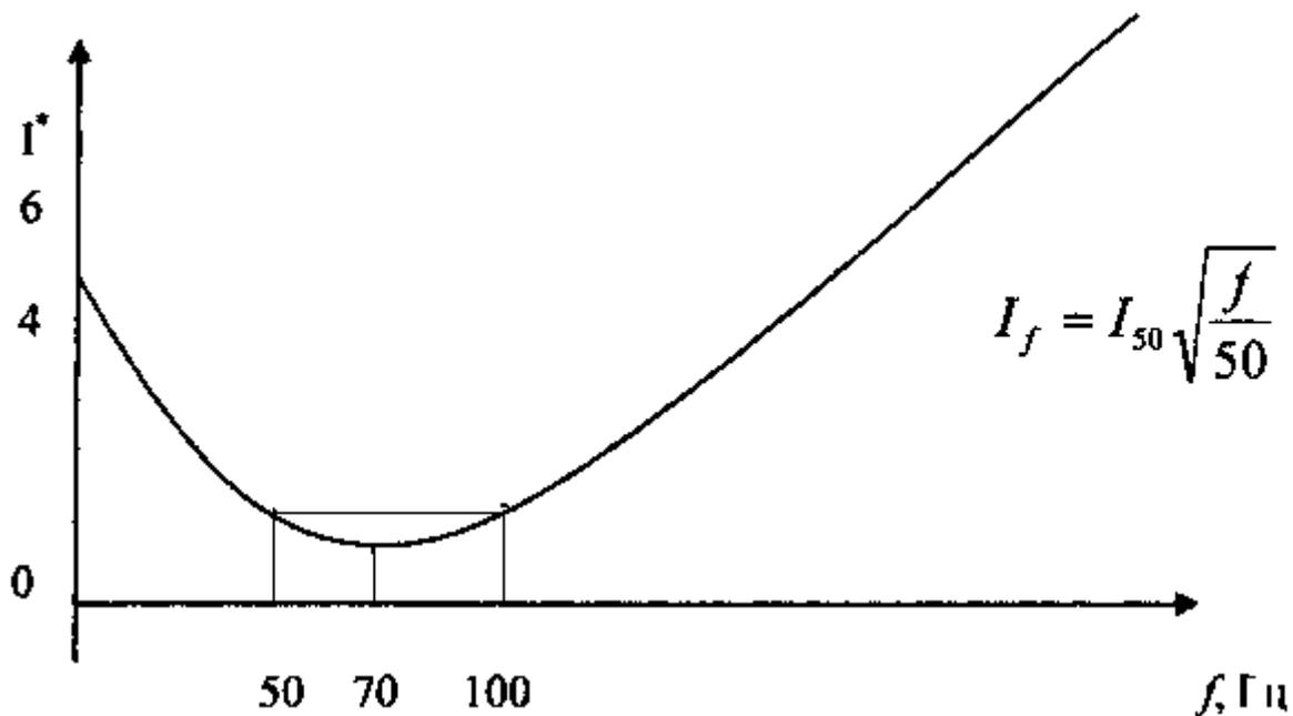
Рисунок В.1 – Зависимость пороговых токов от частоты
