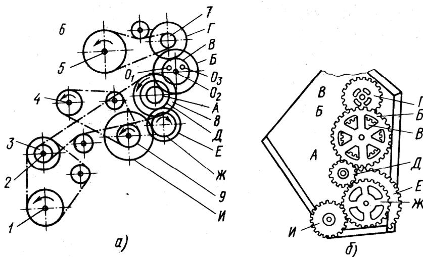
а — кинематическая схема, б — редуктор;
