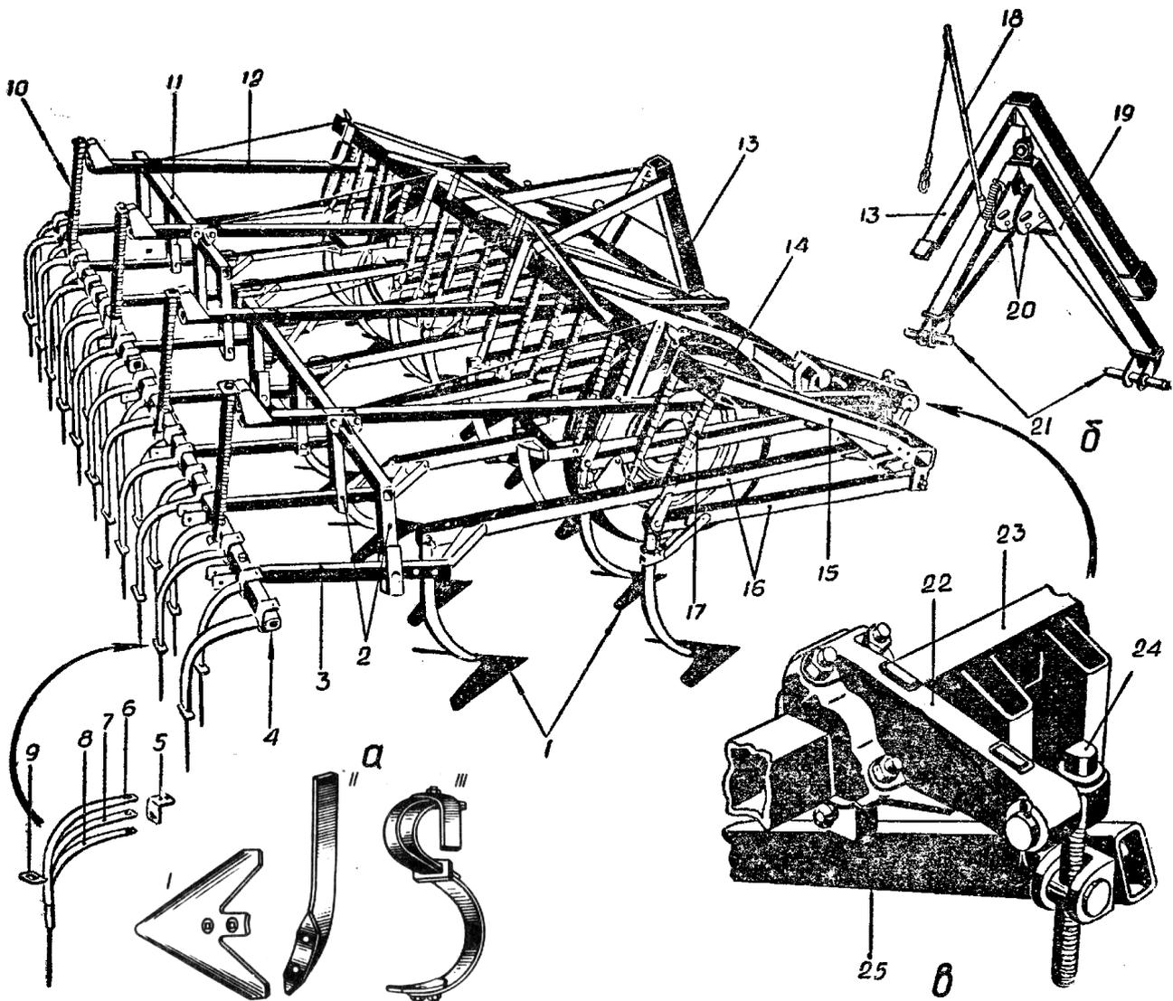
а - общий вид; б- автоматическая сцепка СА-1; в- механизм регулирования глубины обработки; 1- стрельчатые лапы; 2- понизители; 3- поводок; 4- брус секции; 5- скоба; 6 и 7- подпружинники; 8-зуб; 9- хомутик; 10- нажимная штанга; 11- брус; 12- штанга навески борон; 13- замок сцепки; 14- ходовое колесо; 15- рама; 16- грядили; 17- нажим-
