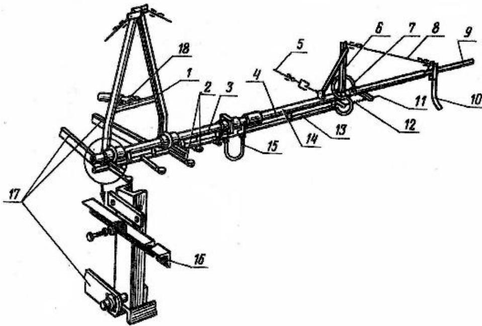
1- стойка; 2- распылитель; 3- средняя секция; 4- промежуточная секция (правая); 5 и 8- тросы; 6- малая стойка; 7 и 15- шланги; 9- крайняя секция (правая); 10- полз; 11- шпилька с гайками; 12- пружина; 13- жидкостная труба; 14- несущая труба; 16- опорный уголок; 17- нижние тяги механизма навески трактора; 18- верхняя центральная тяга
