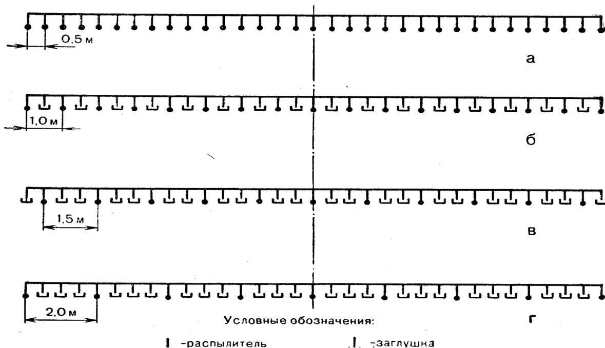
а — 33 распылителя, ширина захвата — 16,5 м; б — 17 распылителей, 16 заглушек, ширина захвата — 17 м; в—11 распылителей, 22 заглушки, ширина захвата — 16,5 м; г — 9 распылителей, 24 заглушки, ширина захвата — 18м
