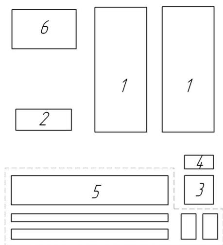
1 - коровник привязного содержания на 100 коров; 2 - ветеринарный пункт со стационаром на четыре места; 3 - кормоприготовительный цех; 4 - здание для автомобильных весов; 5 - склады кормов; 6 - навозохранилище; 7 - водонапорная башня; 8 – выгульная площадка.
