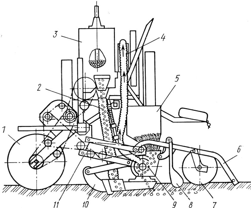
1- колесо; 2- тукопровод; 3- туковывсевающий аппарат; 4- вентилятор; 5- банка высевающей секции; 6- шлейф; 7- прикатывающее колесо; 8- загортач; 9- высевающий аппарат; 10- сошник; 11- параллелограмная подвеска
