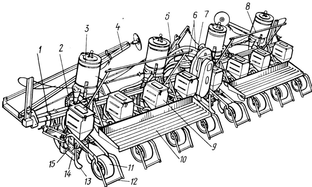
1- рама; 2- тукопровод; 3- туковывсевающий аппарат; 4-маркер; 5- рычаг гидромаркера; 6- пневмопроводы; 7- вентилятор; 8- поручень; 9- банка высевающей секции; 10- подножка; 11-прикатывающее колесо; 12- шлейф; 13- загортач; 14- сошник; 15- высевающий аппарат
