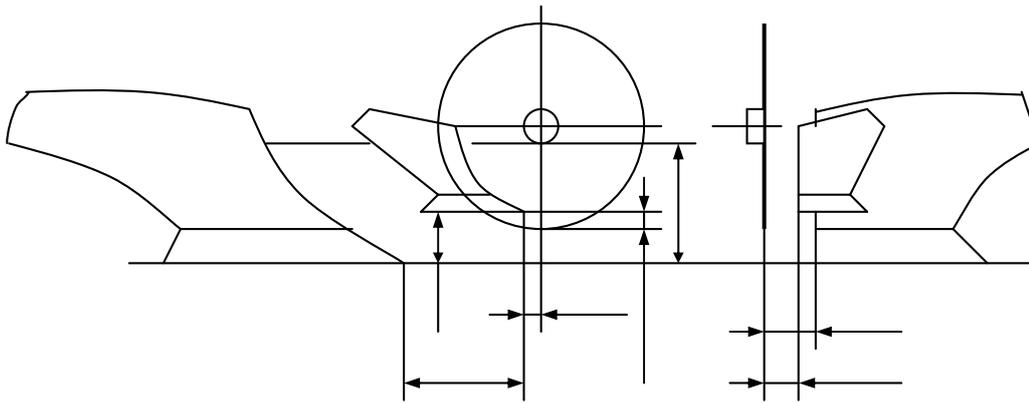
Рисунок 1.3. - Схема установки предплужника и дискового ножа
