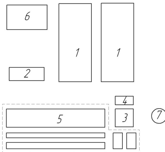
1 - коровник привязного содержания на 100 коров; 2 - ветеринарный пункт со стационаром на четыре места; 3 - кормоприготовительный цех; 4 - здание для автомобильных весов; 5 - склады кормов; 6 - навозохранилище; 7 - водонапорная башня; 8 – выгульная площадка.
