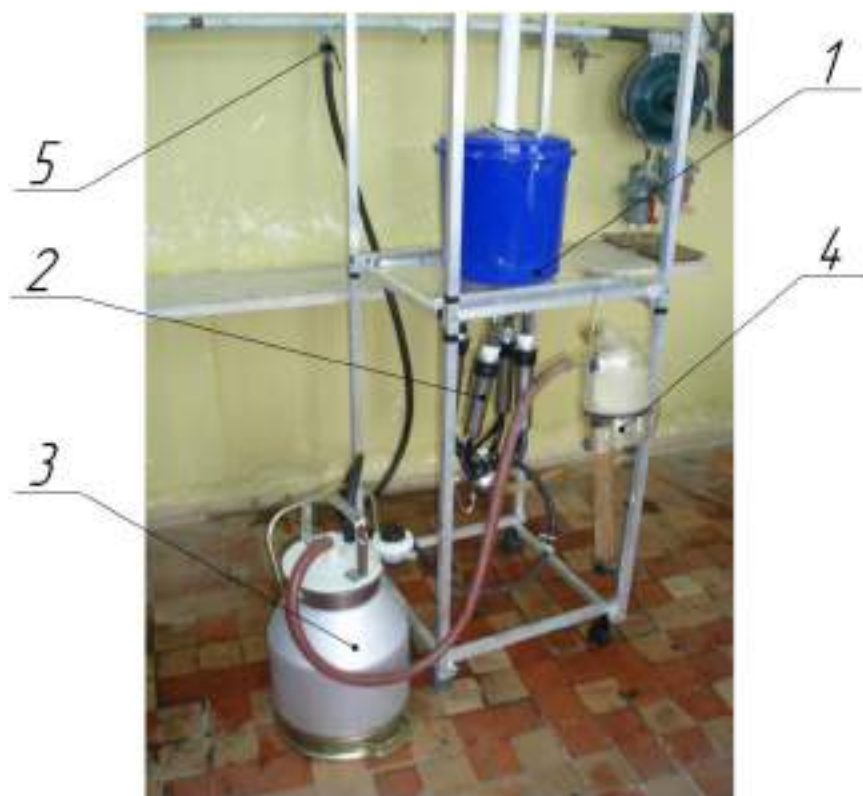
1 – стенд «Искусственное вымя»; 2 – доильный аппарат; 3 – доильное ведро; 4 – устройство зоотехнического учета молока УЗМ-1А; 5 – вакуумный кран доильной установки ДАС-2Б
