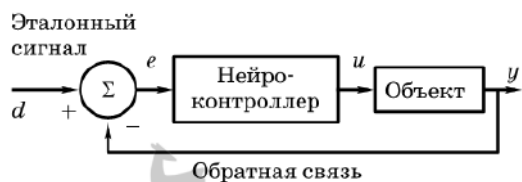
Рисунок 4. Схема управления с обратной связью
