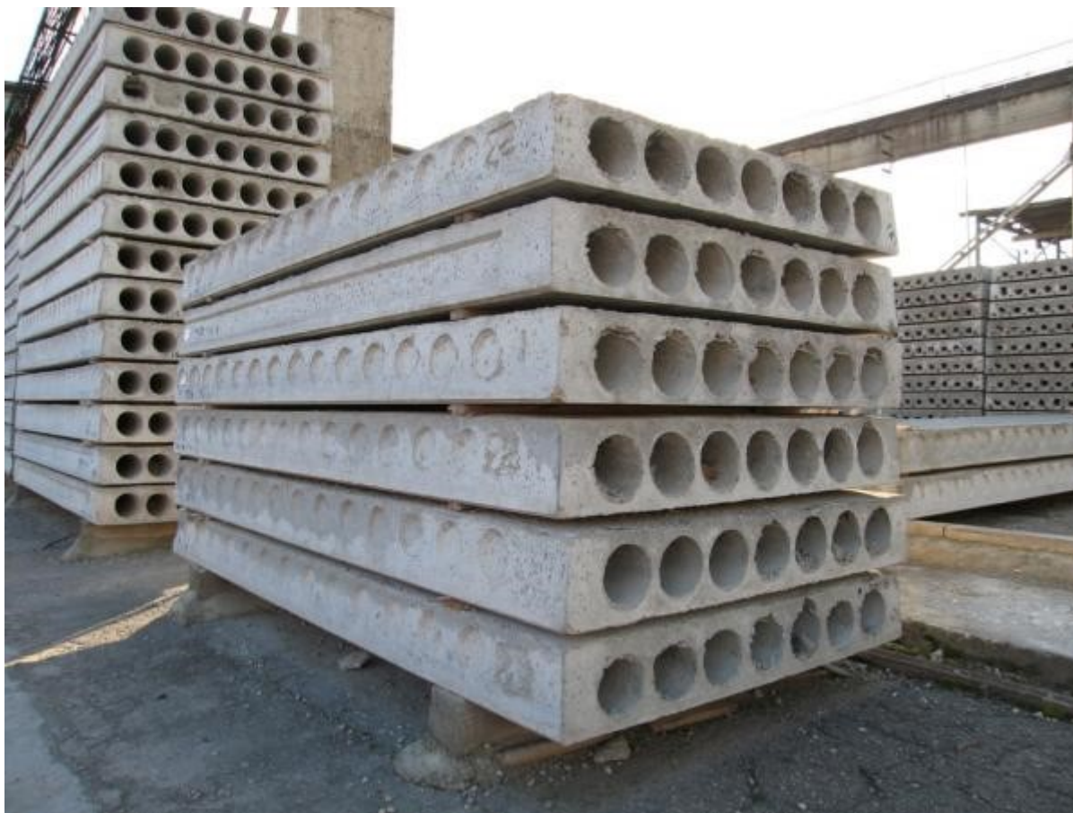
Рисунок 1.5 – Многопустотная плита междуэтажного перекрытия
