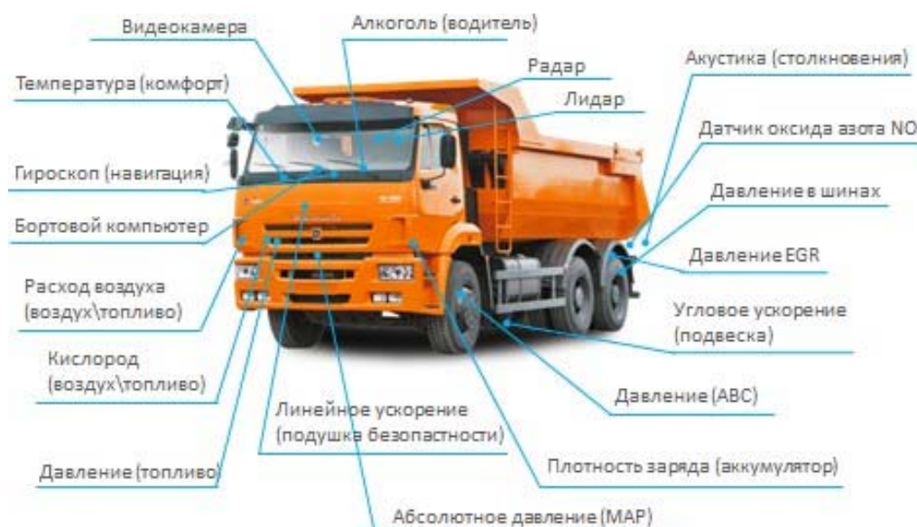
Рис. 3. Элементы МЭМС в реализации беспилотного КАМАЗа
