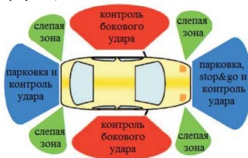
Рисунок 1 – Сфера применений автомобильных радаров ближнего действия
