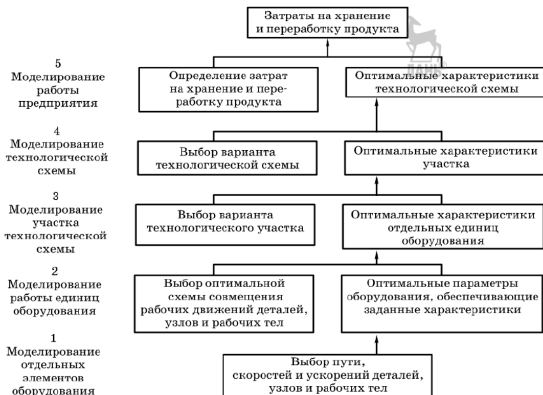
Рисунок 2. Уровни моделирования технологических процессов
