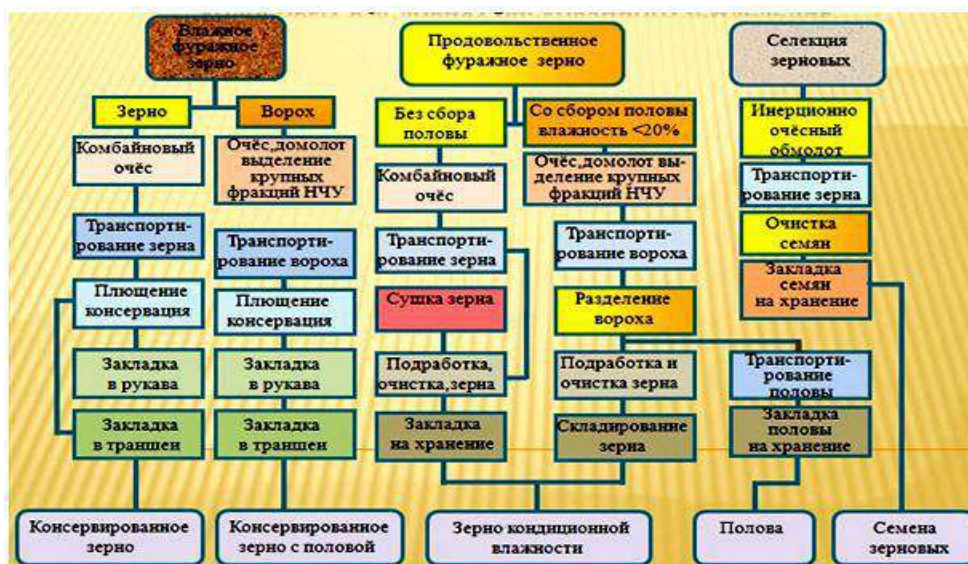
Рисунок 2 – Варианты и структура технологий уборки зерновых колосовых культур очесом в условиях России
