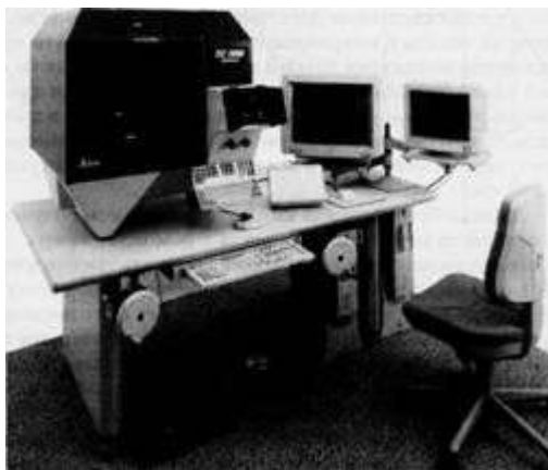
Рис. 6. Стереофотограмметрическая рабочая станция
