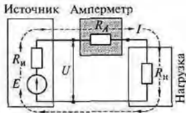
Рис. 2. Влияние амперметра на ток в цепи
