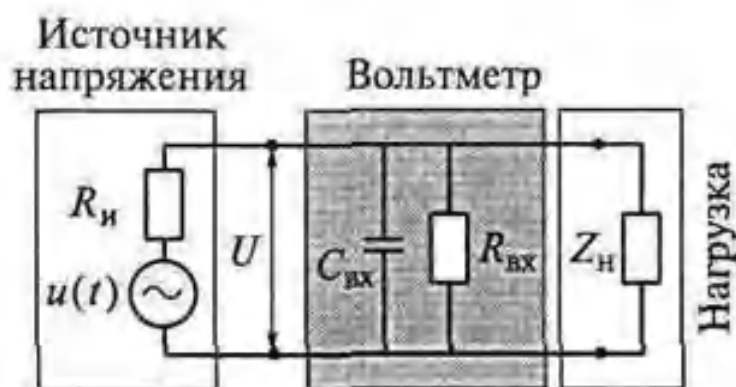
Рис. 3 Погрешность взаимодействия прибора и источника периодического напряжения
