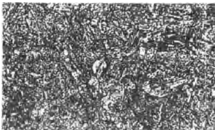
Рисунок 8.8. Микроструктура мартенсита и участков карбидов x200
