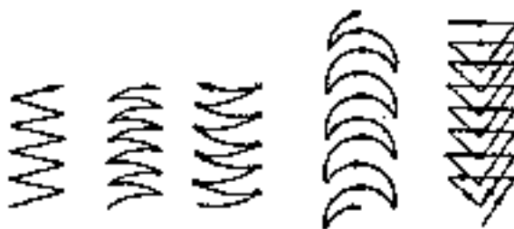
Рисунок 11.8. Поперечные колебательные движения электрода при нанесении уширенных швов
