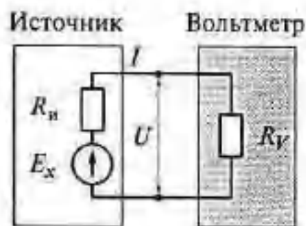
Рис. 1. Погрешность взаимодействия вольтметра и источника напряжения
