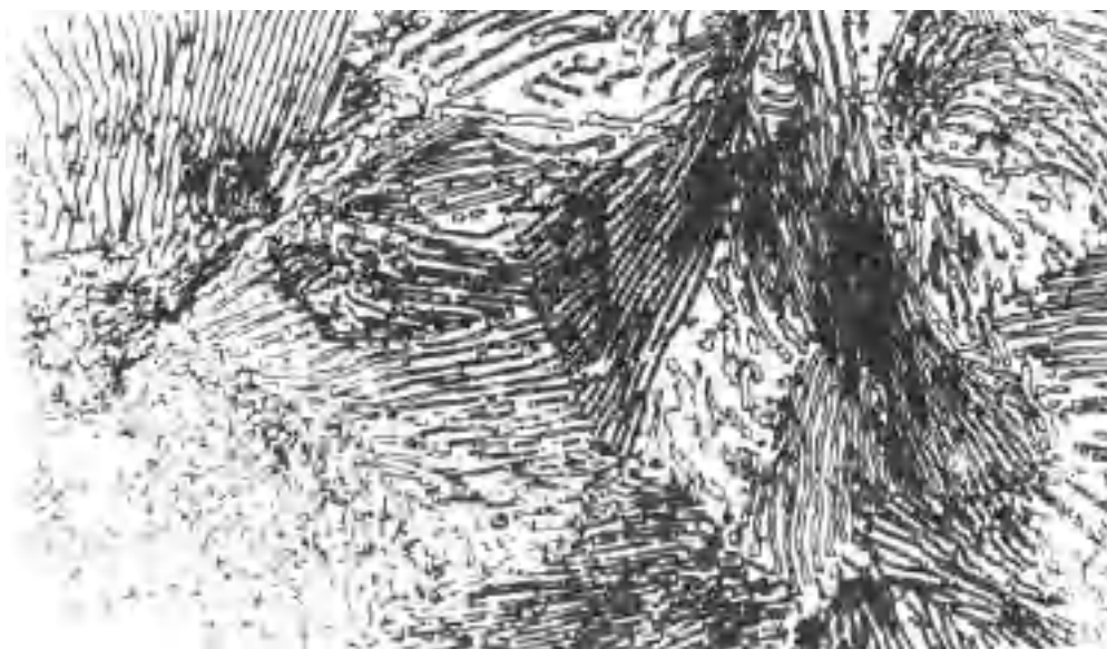
Рисунок 8.2. Микроструктура пластинчатого перлита x500
