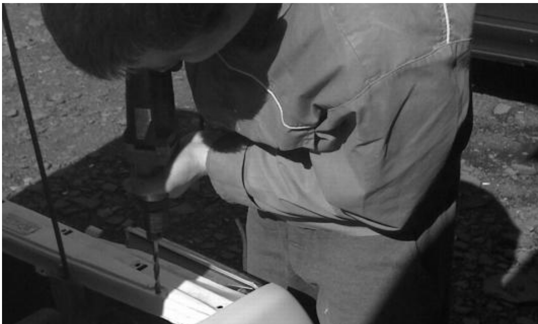
Рисунок 39.1. Прием работы электрической сверлильной машиной.
