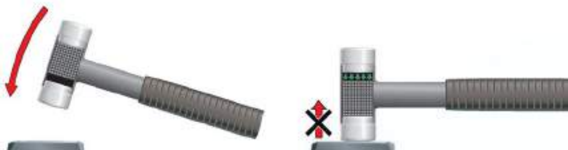
Рисунок 2.2. Принцип работы молотка без отдачи:
