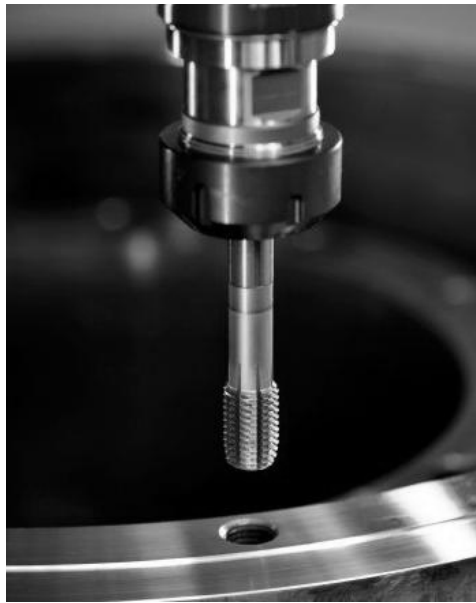
Рисунок 46.2. Прием нарезания резьбы на сверлильном станке.
