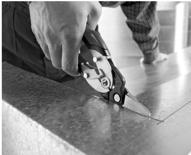
Рисунок 19.2. Положение пальцев на рукоятке при резании ножницами
