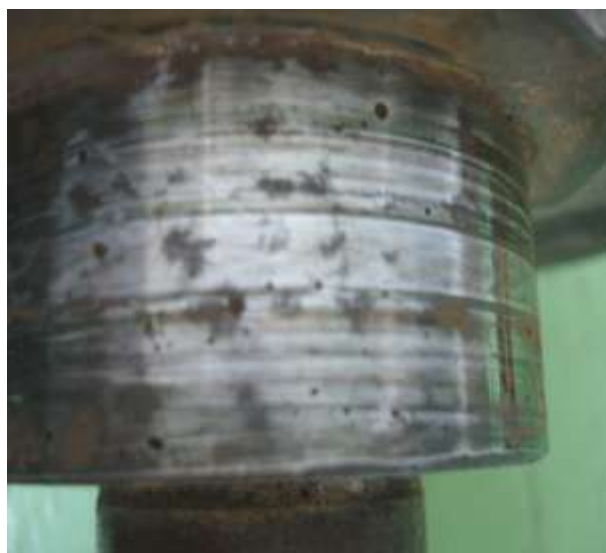
Рисунок 1.10 - Детали, претерпевшие абразивный (а) и гидроабразивный износ (б).
