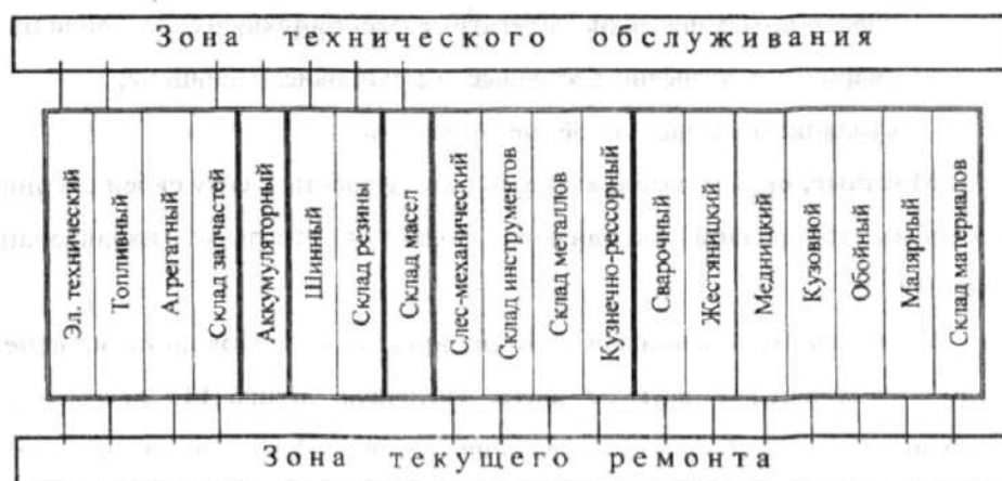
Рис. 7.12. Группировка цехов и их связи с производственными зонами.
