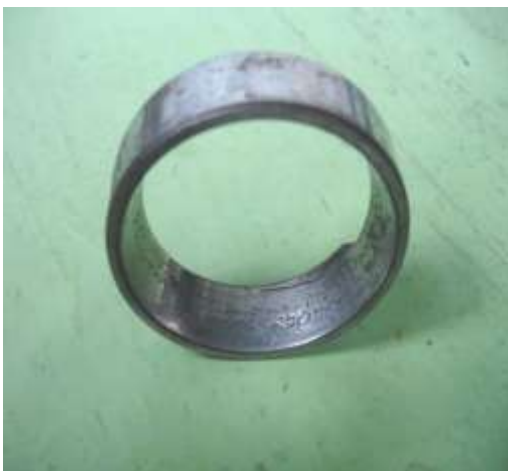
а – шестерня к.п.п.; б – шейка распредвала; в – кольцо подшипника. Рисунок 1.11 – Детали, подвергшиеся усталостному изнашиванию.
