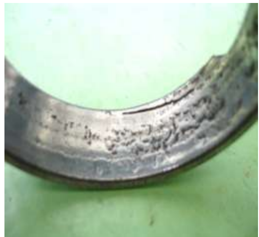
а – шестерня к.п.п.; б – шейка распредвала; в – кольцо подшипника. Рисунок 1.11 – Детали, подвергшиеся усталостному изнашиванию.
