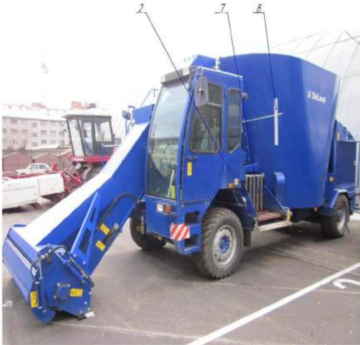
Рисунок 4 - Самоходный смеситель-раздатчик кормов (вид справа)
