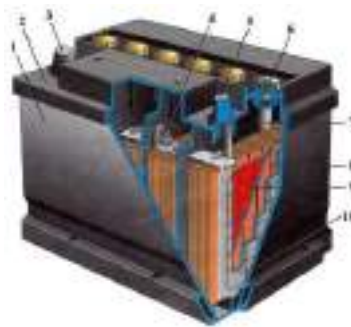
Рисунок 1 Конструкция аккумуляторной батареи типа 6СТ-55П
