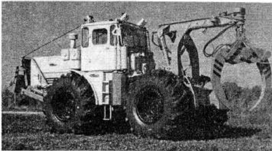
Рис. 8. Колесная бесчокерная трелевочная машина МЛ-30
