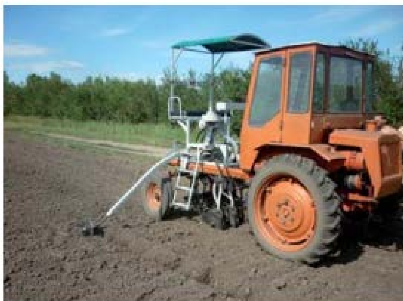
П.А.Р.1- Селекционная навесная сеялка ССФК-7
