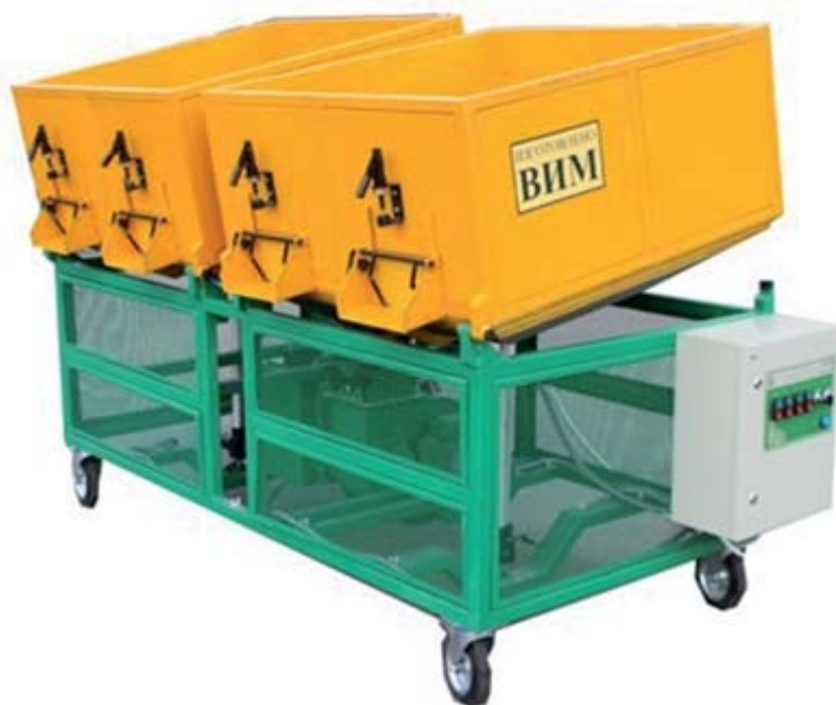
П.А.Р.10 -Сушилка лотковая селекционная СЛ-0,3и2
