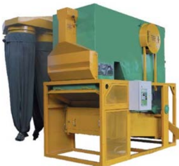
П.А.Р.12- Семяочистительная воздушно-решетная машина ВИМ-12/25
