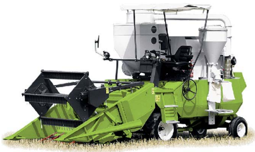
П.А.Р.8- Малогабаритный селекционный комбайн«Classic» Wintersteigen-ВИМ
