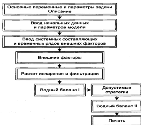
Рисунок 3. Блок-схема расчета водного баланса на ЭВМ
