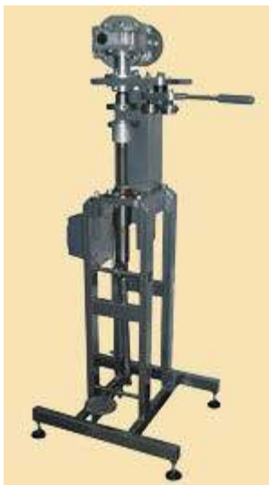
Рисунок 29 - Машина укупорочная (закатка крышек) ИПКС-127УЗ.
