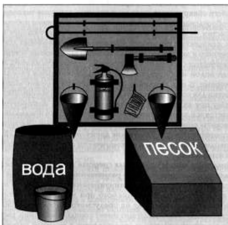
Рисунок 1. Пожарный щит первичных средств пожаротушения
