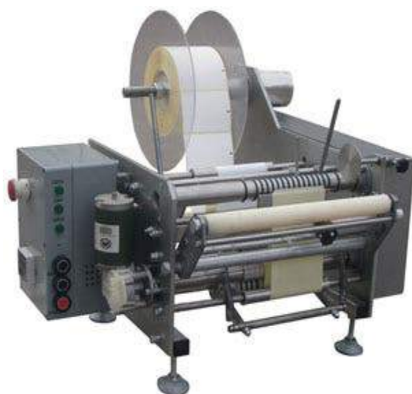
Рисунок 30 - Установка для нанесения этикеток ИПКС-099Ц.
