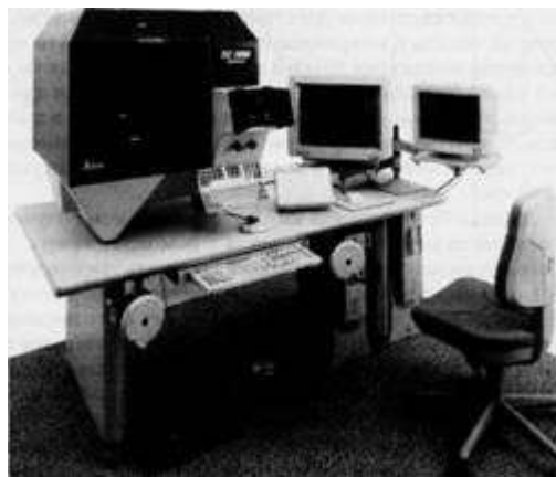
Рис. 6. Стереофотограмметрическая рабочая станция
