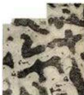
Рисунок 1.3. Микроструктура литой оловянистой бронзы Бр.010
