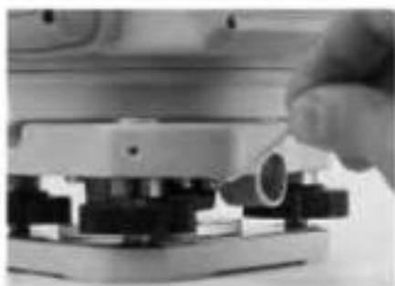
Рисунок 11 – Центрирование геодезита
