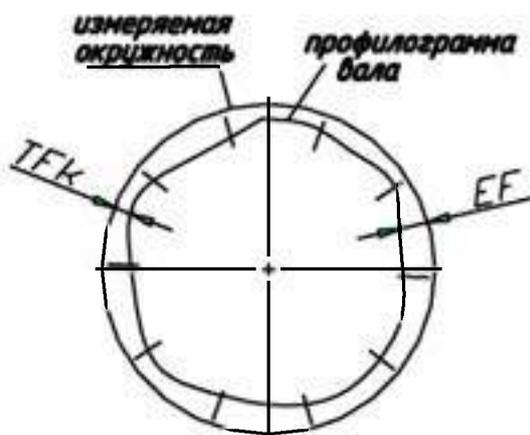
Кругломеры обеспечивают точное относительное смещение преобразователя и контролируемой детали. При этом в случае отклонения поперечного сечения детали от правильной окружности перемещаемый наконечник получает перемещения, которые усиливаются усилителем и записываются в виде профилограммы. Для определения отклонения от круглости на профилограмму накладывают прилегающую окружность.
