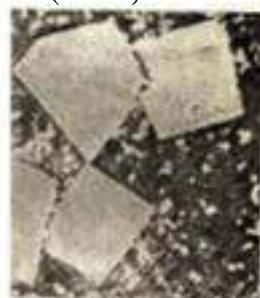
Рисунок 1.6. Микроструктура оловянистого баббита Б83.
