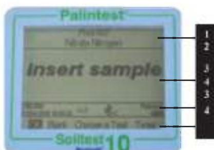
отображаться в виде списка. Выберите, используя стрелки вверх / вниз 3. Информационная панель - отображает значки состояния, дату и время и образец идентификатор оператора. 4. Действие выбора - варианты отображаются в виде строки. Используйте стрелки влево / вправо, чтобы выбрать.
