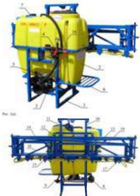
1 - рама; 2 - бак основной; 3 - насос; 4 - регулятор давления; 6 - гидромешалка; 7 - бак для мытья рук; 8 - фильтр всасывания; 11 - лебедка механизма подъема; 12 - раскос; 13 секция центральная; 14 - секция промежуточная; 15 - предохранительный механизм; 16 - уровнемер; 17 - узел распыла; 18 - концевик; 19 - секция крайняя.
