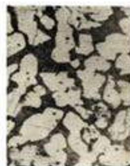
Рисунок 1.2. Микроструктура литой латуни ЛС59-1 (X200).
