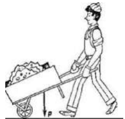
Рисунок 2. Тачка как рычаг
