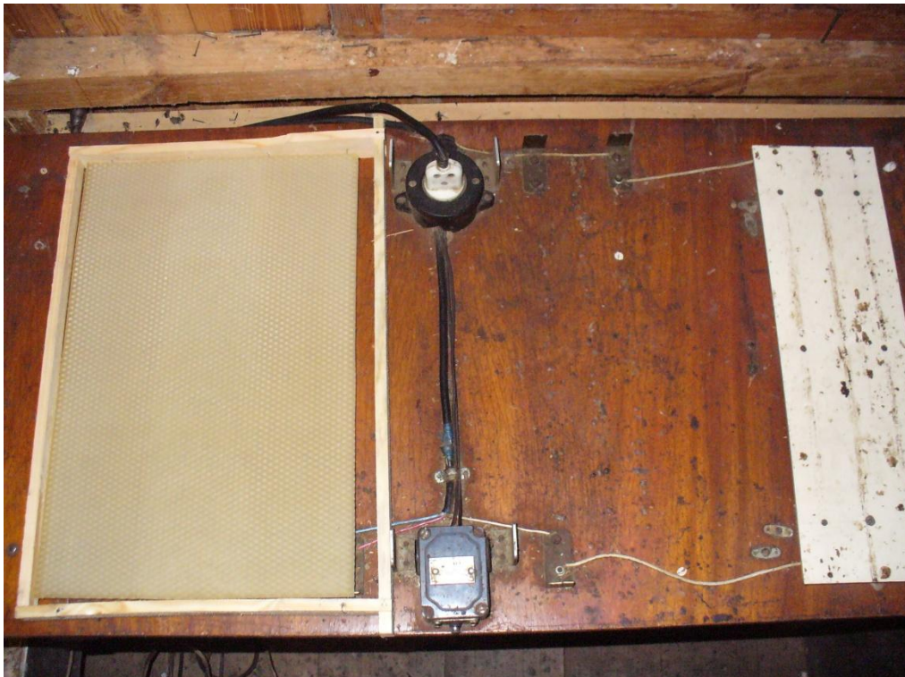
Рис .40. Станок для натягивания проволоки в рамках.
