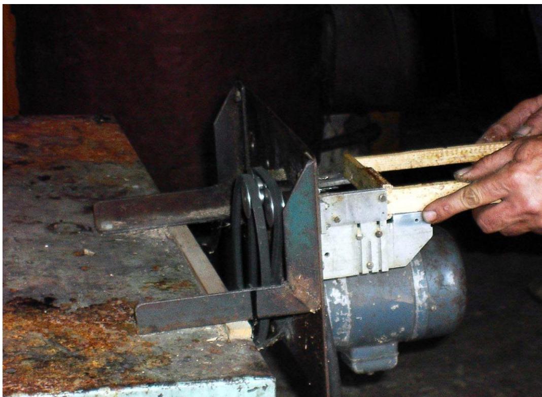
Рис. 38. Сверление отверстий в рамках.
