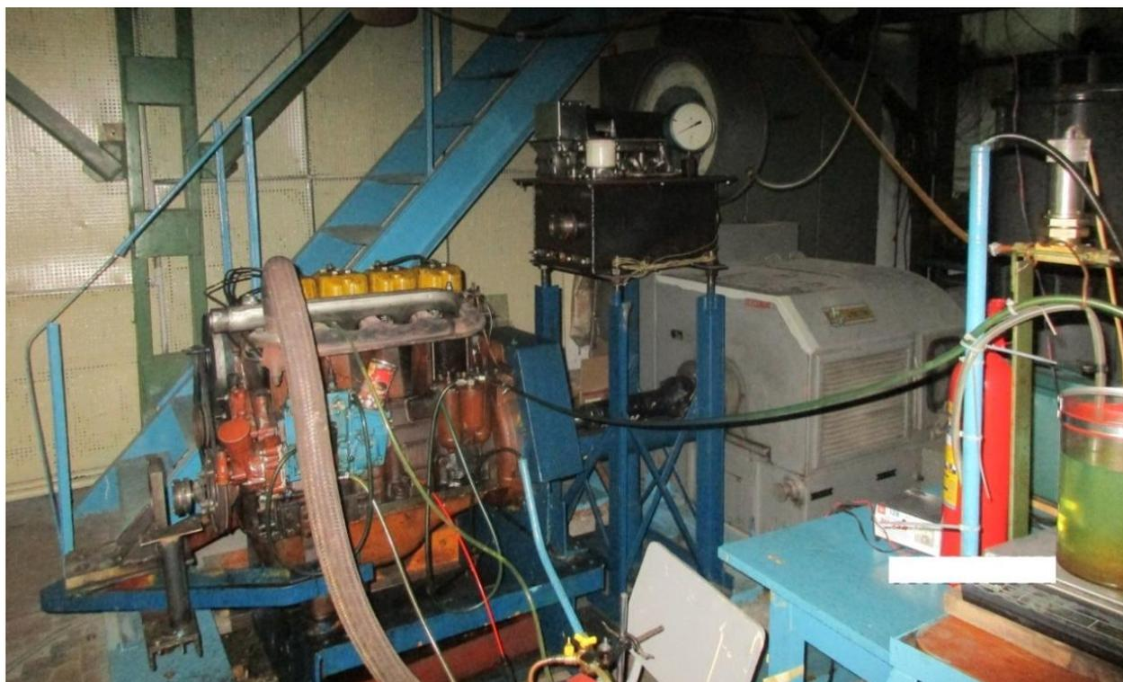
Рисунок 5.2 - Общий вид экспериментального стенда с дизельным двигателем Д-144
