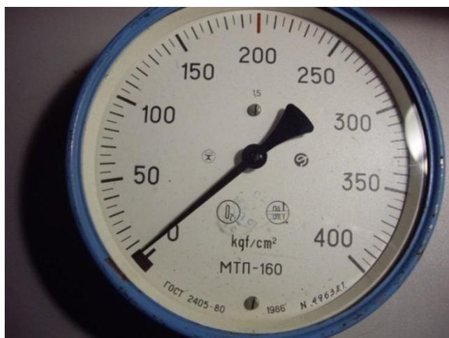
Рисунок 2.7 - Манометр для тарировки датчиков
