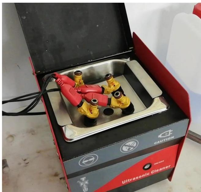
Рисунок 3.6 – Ультразвуковая ванна «Ultrasonic Cleaner»
