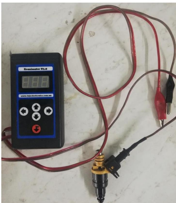
Рисунок 3.1 – Прибор Reanimator Injector v 2.0 (Реаниматор форсунок)
