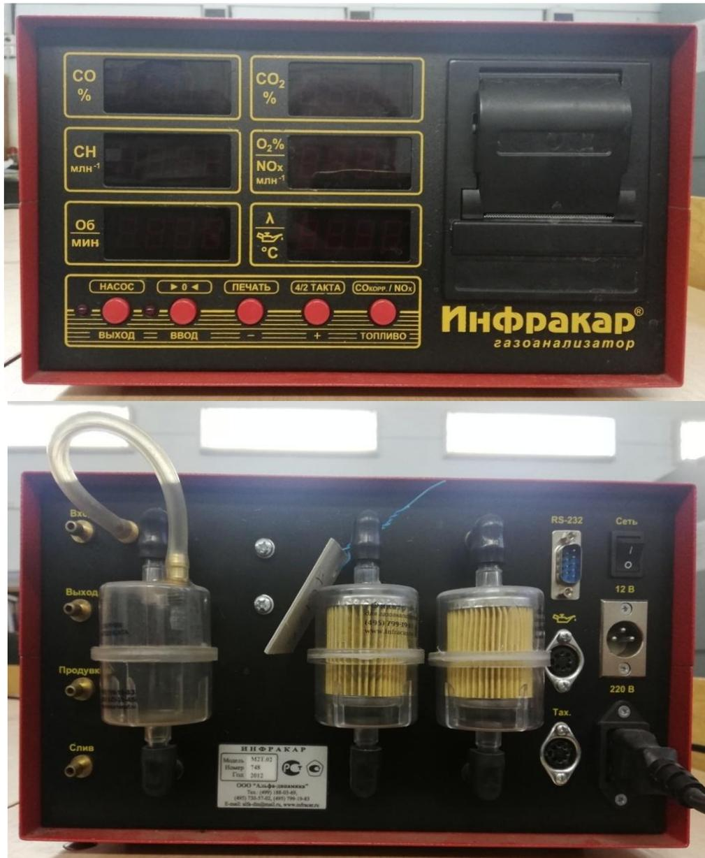
Рисунок 3.22 – Внешний вид газоанализатора Инфракар М-2Т.01
