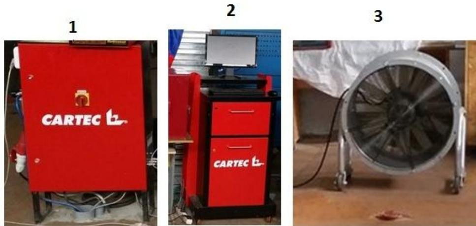
Рисунок 3.12. 1 – силовой шкаф; 2 – стойка управления с комплектом ПК; 3 – напольный вентилятор.
