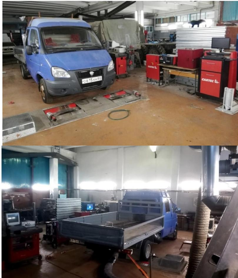
Рисунок 3.9 – Стенд с беговыми барабанами и ГАЗ 27040V «Фермер»
