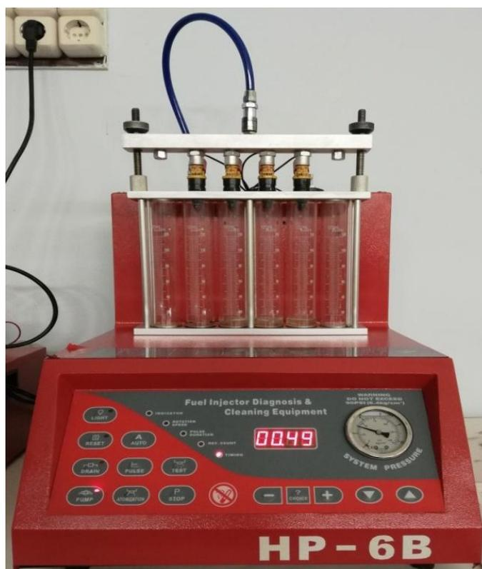
Рисунок 3.4 – Установка AE&T «HP-6B» для оценки технического состояния топливных форсунок
