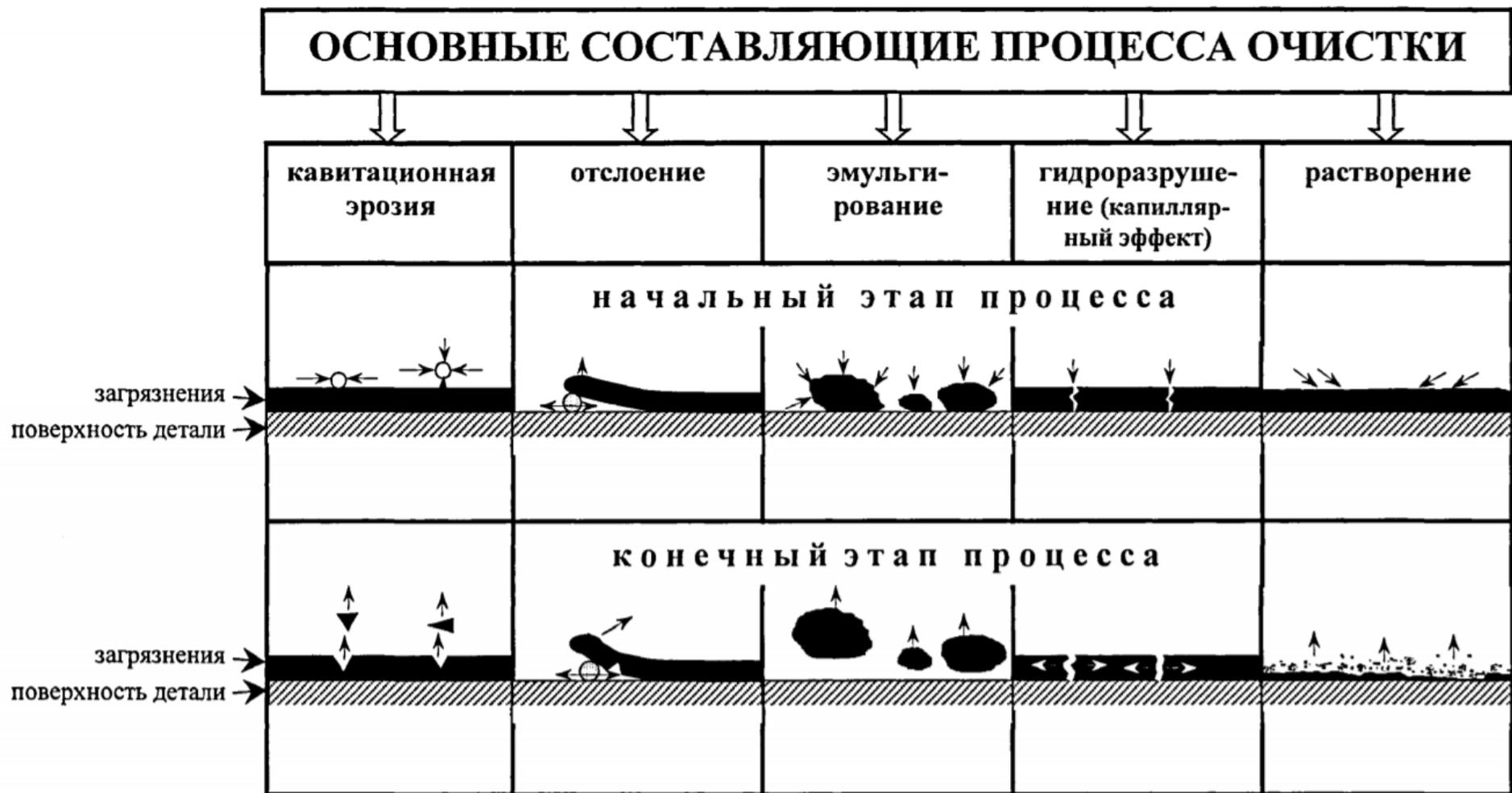
Рисунок 1.9 – Схема разрушения загрязнений моющим раствором в ультразвуковом поле: О и О - кавитационные захлопывающиеся и пульсирующие пузырьки; ->- направление действия основных составляющих сил процесса очистки
