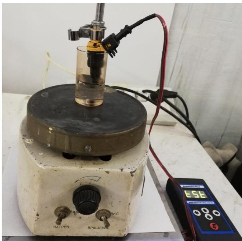
Рисунок 3.2 – Общая схема лабораторной установки
