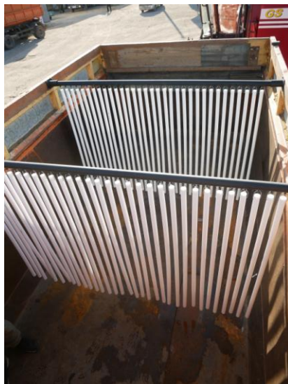
Рисунок 5. Общий вид кузова автомобиля МАЗ 5516, оборудованного поперечными эластичными перегородками
