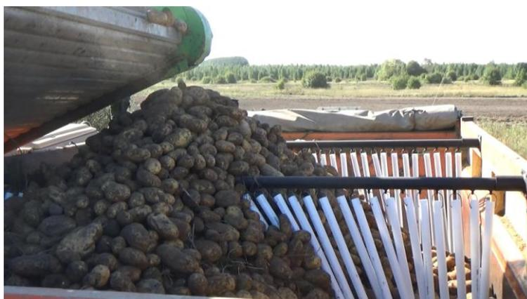
Рисунок 4.8. Загрузка автомобиля МАЗ 5516, оборудованного поперечными эластичными перегородками
