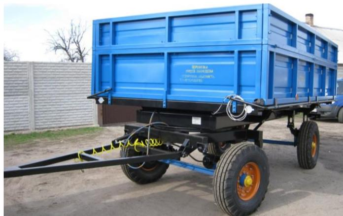
Рисунок 1.6. Тракторный самосвальный прицеп 2 ПТС 4.
