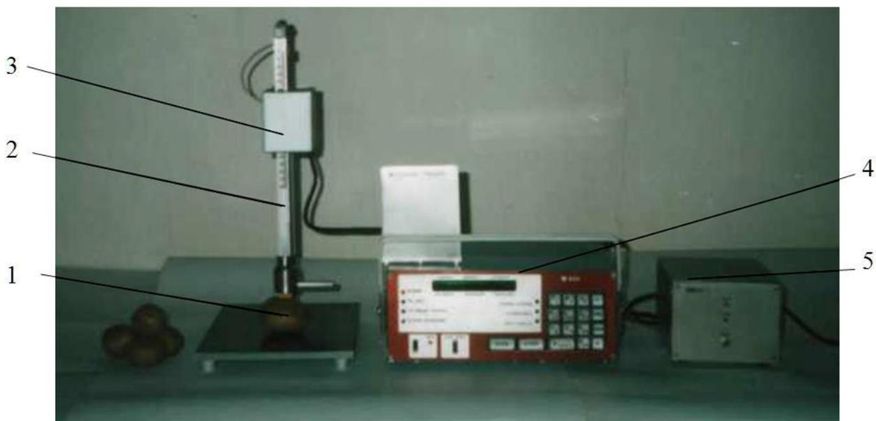
1 – клубень; 2 – измерительный шуп; 3 – измерительный блок; 4 – блок управления; 5 – блок питания.
