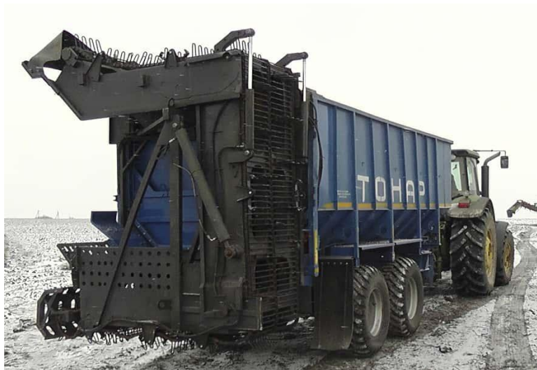
Рисунок 1.8. Транспортное средство, оборудованное выгрузным транспортером
