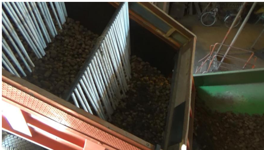
Рисунок 4.6. Окончание выгрузки клубней картофеля из кузова автомобиля, оборудованного поперечными эластичными перегородками
