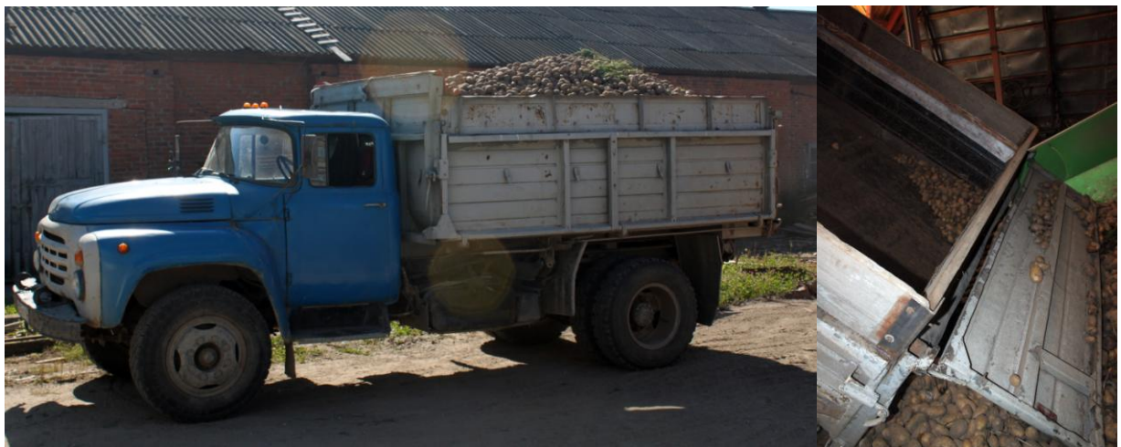
Рисунок 1.11. Используемые транспортные средства при перевозке картофеля с верхней подвеской заднего борта
