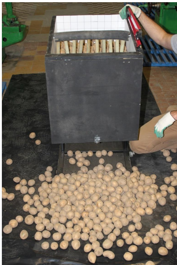
Рисунок 3.4. Общий вид контейнера, оборудованного эластичной перегородкой при исследовании раската клубней картофеля
