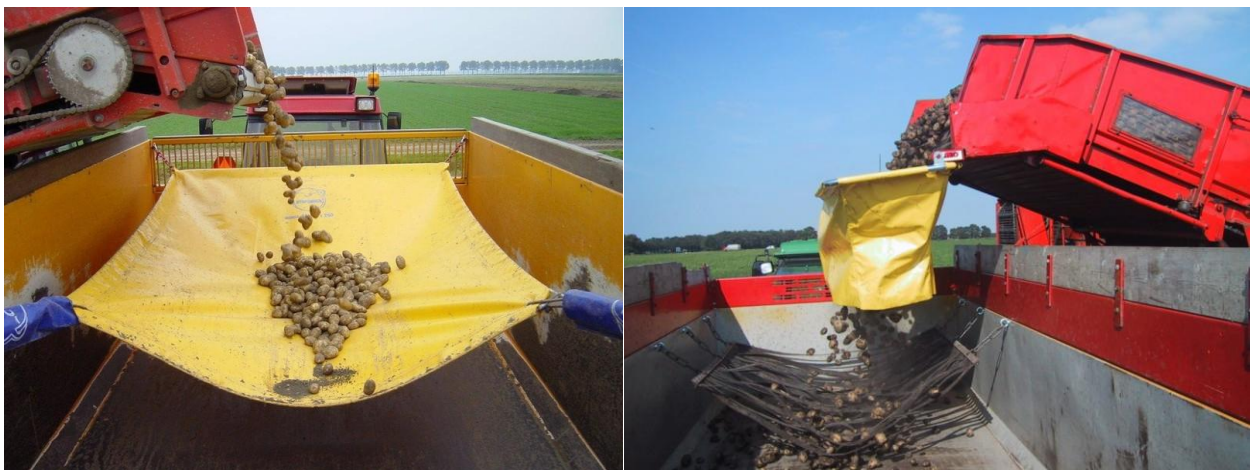
Рисунок 1.10. Гасители падения клубней картофеля в кузове транспортного средства
