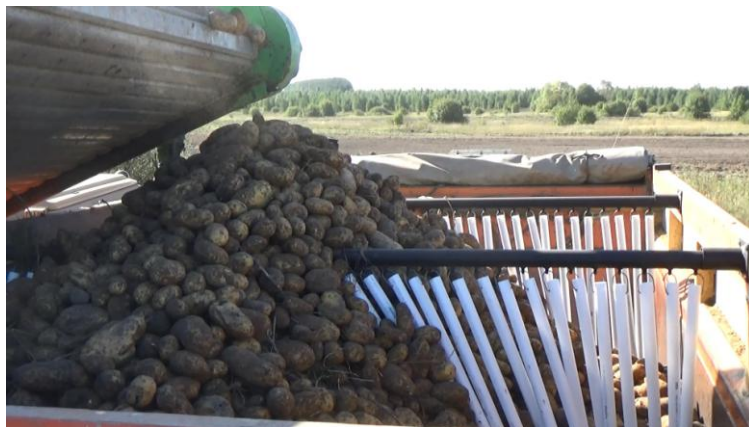
Рисунок 4.8. Загрузка автомобиля МАЗ 5516, оборудованного поперечными эластичными перегородками
