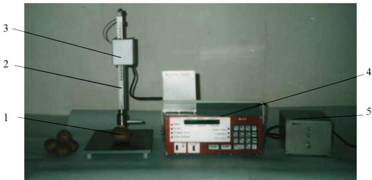
1 – клубень; 2 – измерительный шуп; 3 – измерительный блок; 4 – блок управления; 5 – блок питания.
