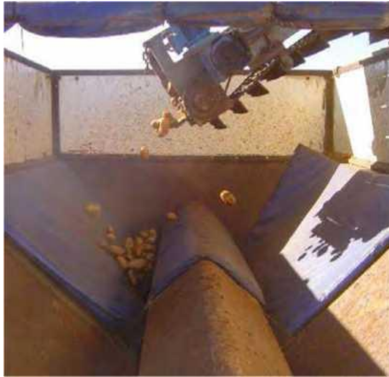
Рисунок 1.9. Покрытие прорезиненным полотном защитного козырька, расположенного над выгрузным подвижным транспортёром кузова транспортного средства
