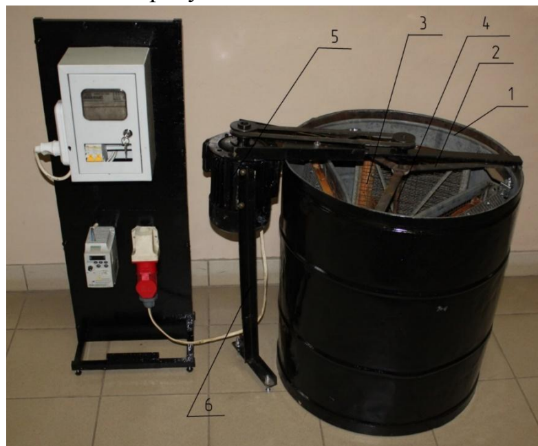
1 - цилиндрическая емкость, 2 – ротор, 3 – кассета, 4 - вал, 5 – привод, 6 – опора.
