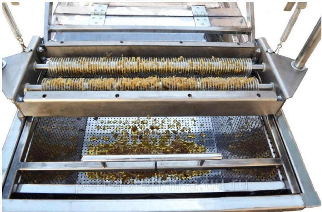
Рисунок 1.5 - Общий вид станка для распечатки сотовых рамок с роликовыми ножами
