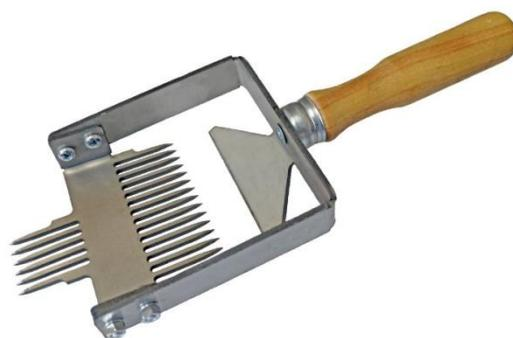
Рисунок 1.4 - Общий вид вилки для распечатки сотов
