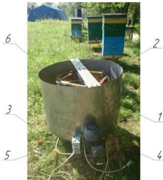
1 – корпус; 2 - ротор с кассетами; 3- основание; 4 электродвигатель; 5 пульт управления; 6- перговые рамки
