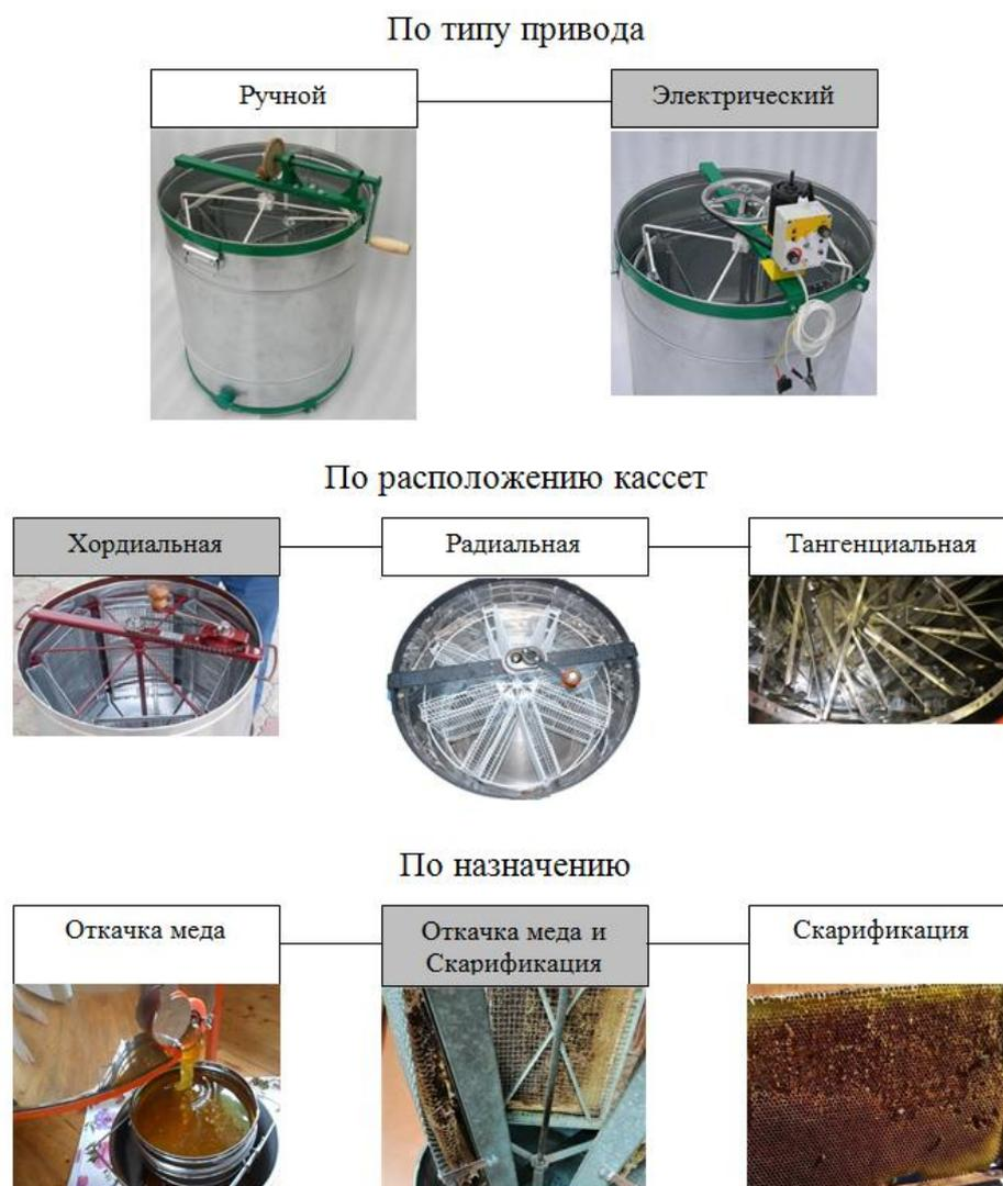
Рисунок 1.2 – Классификация агрегатов для извлечения меда и скарификации перговых сот
