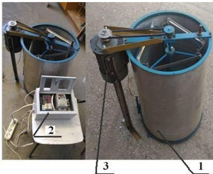
1 – центробежный агрегат; 2 – частотный преобразователь DELTA VFD 007L 21B; 3 – электродвигатель.
