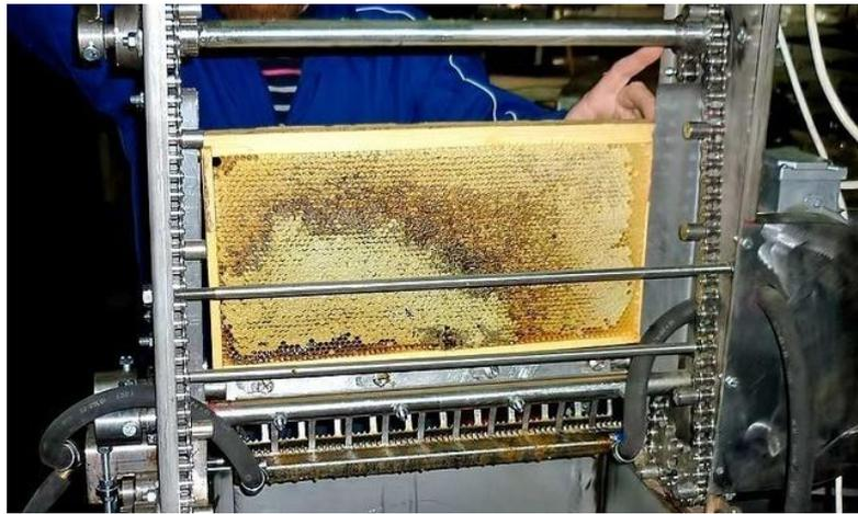
Рисунок 1.6 - Общий вид станка для распечатки сотовых рамок с вибрационными ножами
