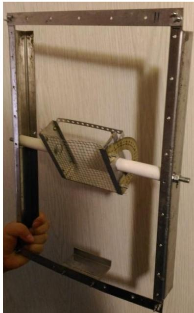
Рисунок 4.11 –Специальная кассета для определения зависимости зависимости количества оставшегося меда от угла наклона рамки и угловой скорости ротора.
