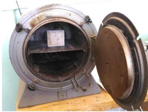
Рисунок 4.6 –Сушильный шкаф ВШ-0,035 с помещенной в него рамкой уменьшенного размера
