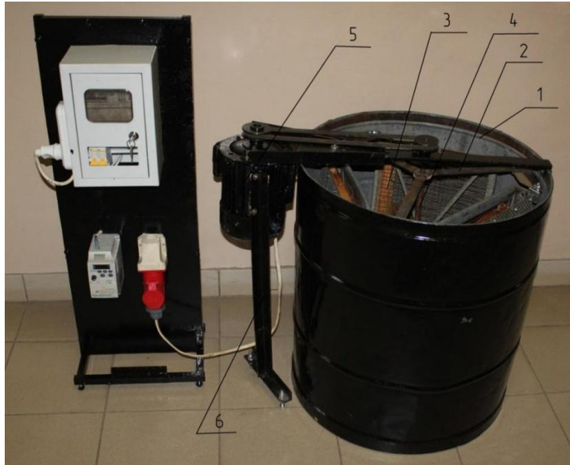
1 - цилиндрическая емкость, 2 – ротор, 3 – кассета, 4 - вал, 5 – привод, 6 – опора.
