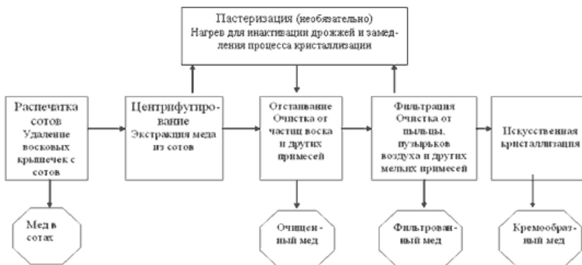
Рисунок 1.1 – Технологический процесс центробежного извлечения меда
