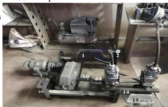
Рисунок 6– Стенд для износных испытаний компрессоров:
