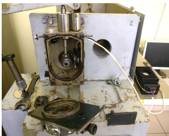
Рис. 3.11а - Общий вид испытательной камеры типа T251.
