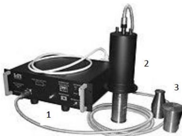
Рисунок 1.4 - Установка ИЛ 100/6: 1 - ультразвуковой генератор; 2 - магнитострикционный преобразователь; 3 - волноводы.
