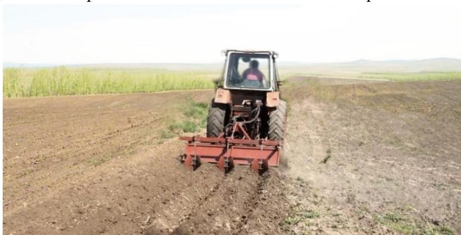
Рисунок 10 – Почвообрабатывающая фреза ФН-1,2М в работе
