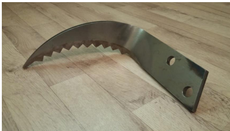
Рисунок 1.10 – Нож почвообрабатывающей фрезы зубцеобразной формы
