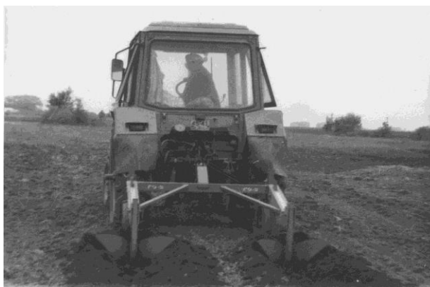
Рисунок 1.1 – Общий вид грядообразователя ГО-2
