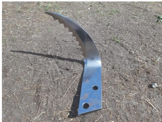
Рисунок 2.10 – Нож почвообрабатывающей фрезы с зубцеобразным профилем
