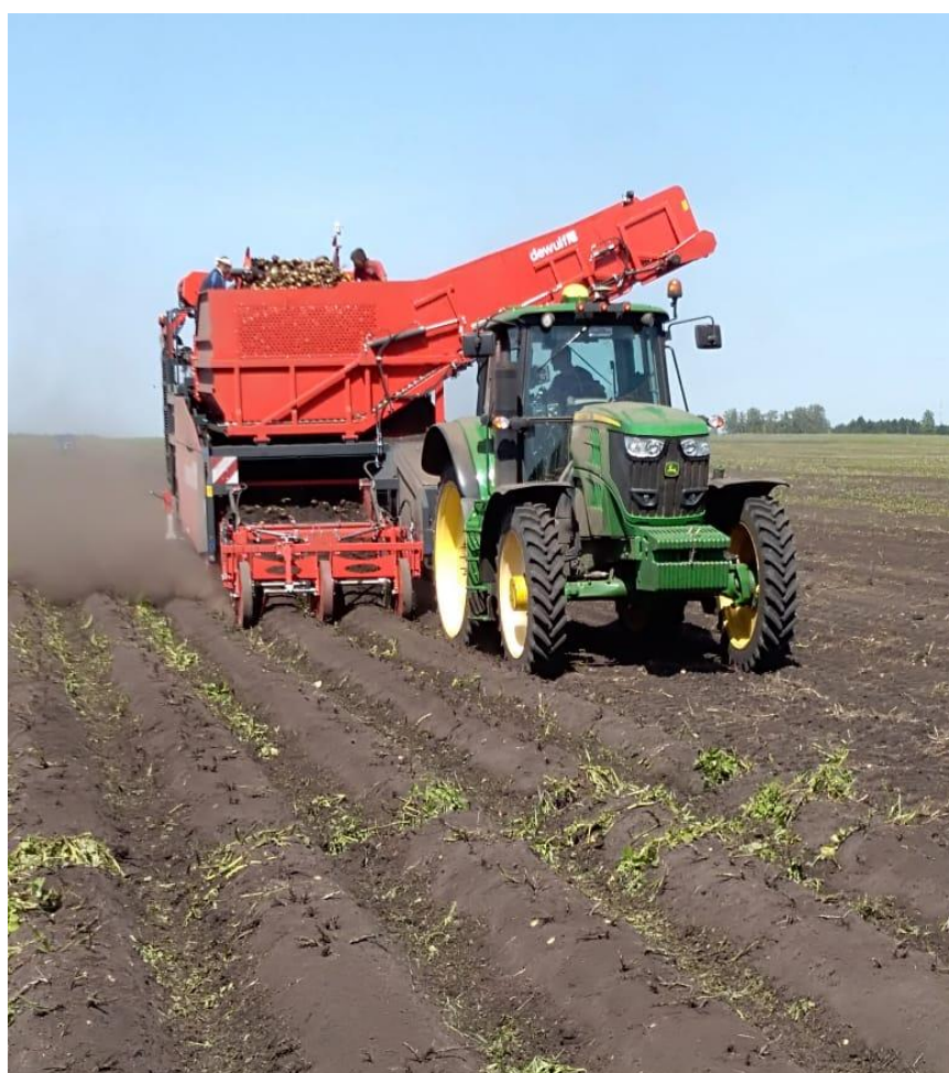
Рисунок 4.2 – Картофелеуборочный комбайн Dewulf в работе
