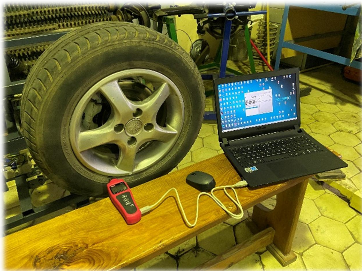
Рисунок 5 – Измерение частоты вращения колеса при торможении в процессе стендовых испытаний программно-аппаратным комплексом UNIT-372
