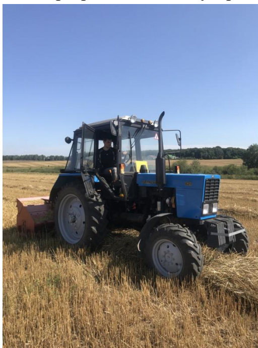
Рисунок 9 – Измельчитель–мульчировщик Kverneland FX-230, оборудованный разравнивающим устройством в агрегате с трактором МТЗ-82 во время хозяйственных испытаний
