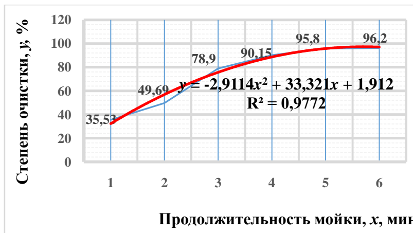
Рисунок 9 – Изменение степени очистки образцов в зависимости от продолжительности мойки с активацией моющего раствора колебанием омывательной корзины
